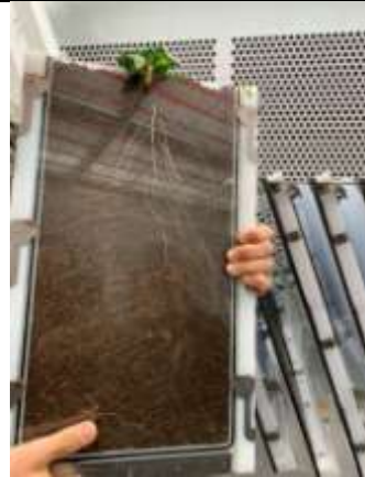
高通量根部表型系統，以土壤為介質，觀察根系生長。
