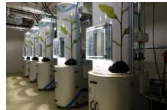
第 1 個模組為完全封閉且受控的生態系統組成。可直接由上方壓克力透明窗觀察內部植物生長。
