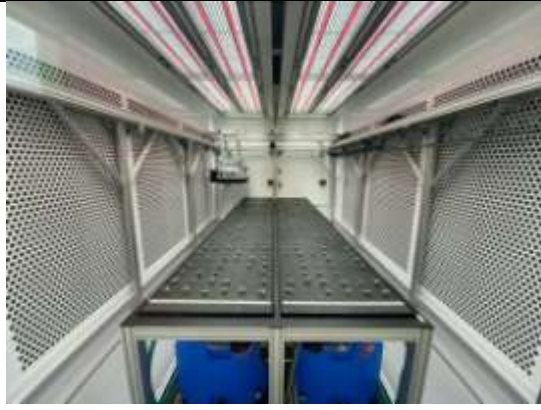
第 4 模組為環控生長室，上方有移動感測器，定時掃描植物生長狀態。
