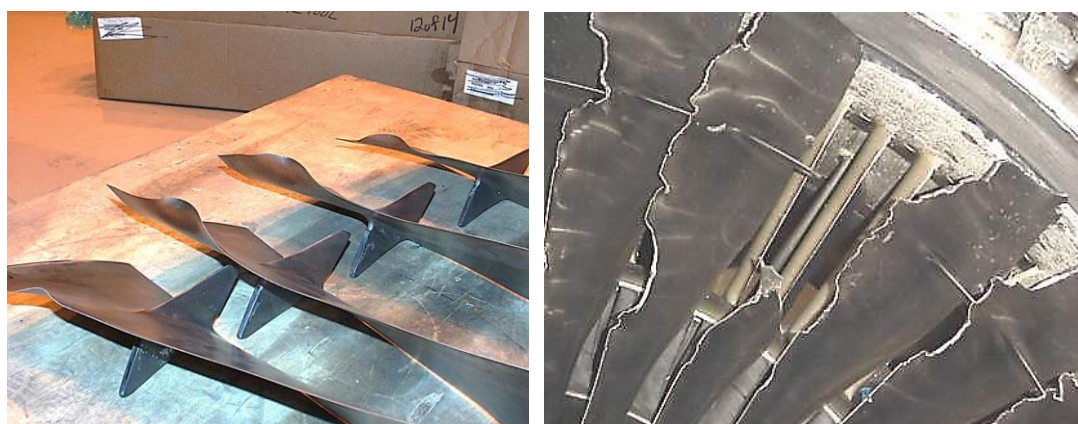
圖 3.4-9 發動機風扇/葉片損傷實例（左：柔性，右：剛性）
