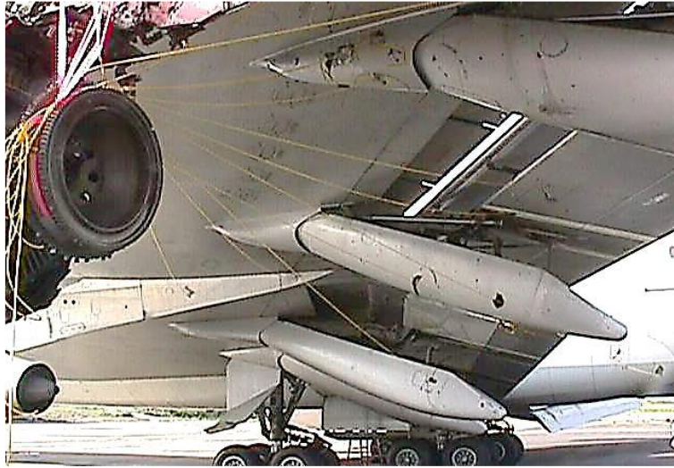
圖 3.4-11 破損零件/碎片散射路徑重建
