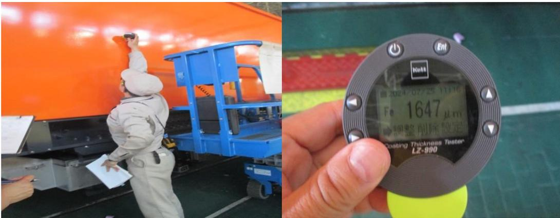
圖 4-21 機械室側牆總成塗裝膜厚
