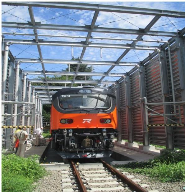
圖 4-35 拉車進水密測試處
