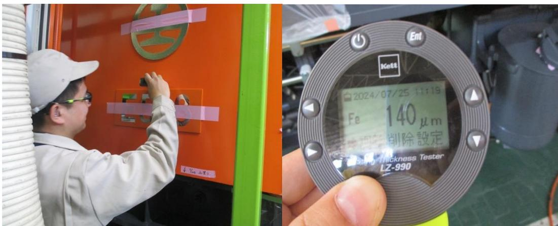
圖 4-22 機械室側牆總成塗裝膜厚
