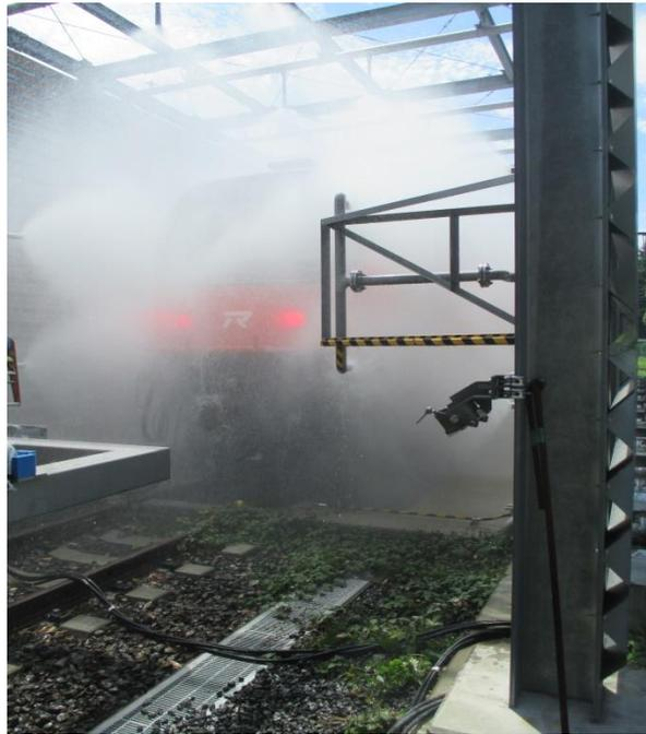
圖 4-37、4-38 車輛連續灑水 10 分鐘,過 5 分鐘後檢查
