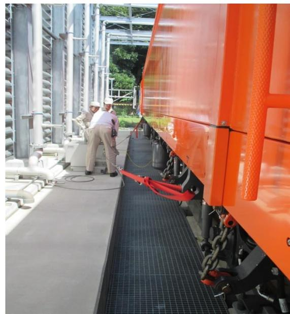
圖 4-36 絞盤拉線安裝在車上
