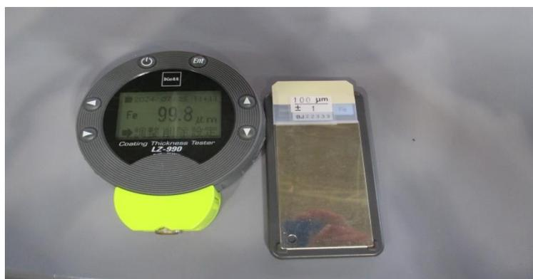
圖 4-18 配合校正塊確認精準度
