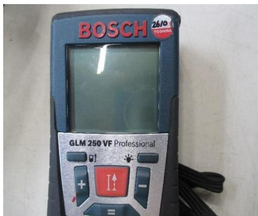
圖 4-14 雷射測距儀
