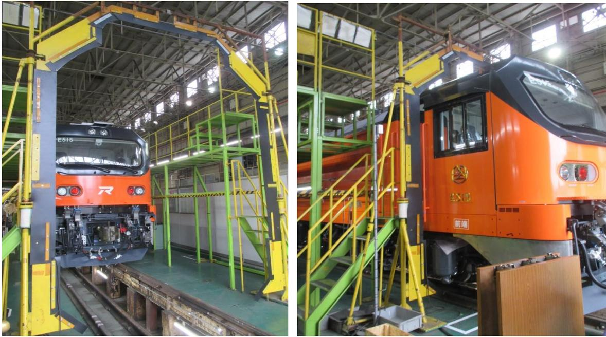
圖 4-11、圖 4-12 測試機車通過車輛界限規
