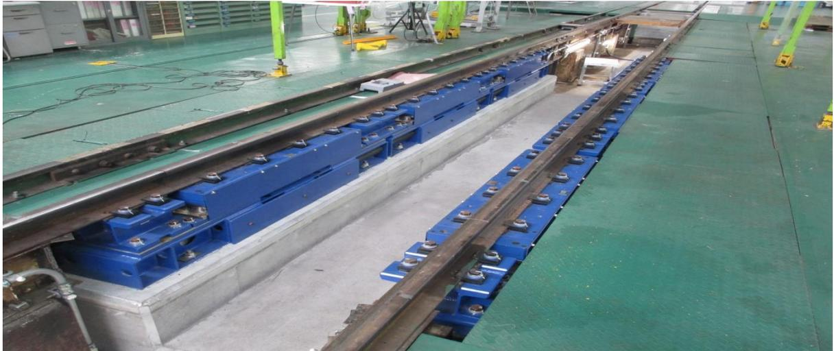
圖 4-2 軸重量測設備
