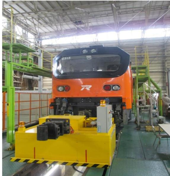
圖 4-10 測試機車和牽引車掛在一起
