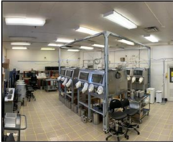
圖 12 模擬的放射性物質生產設施測試環境(包含鉛製手套箱和不銹鋼容器)
