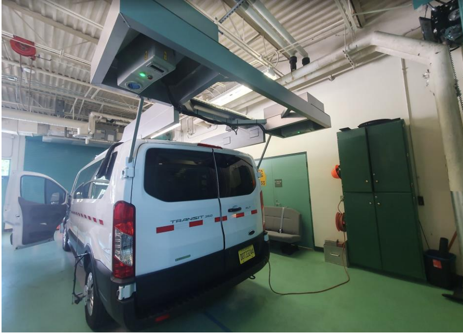
圖 37 LCSM 檢測車的裂縫偵測雷射
