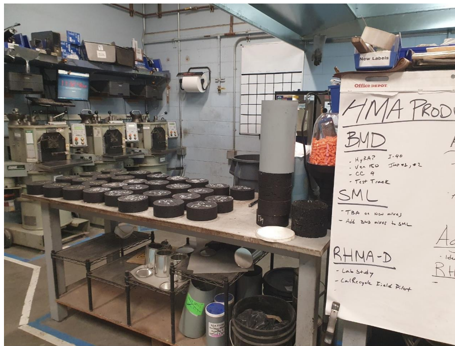
圖 61 製作完成的 SGC 瀝青混凝土試體
