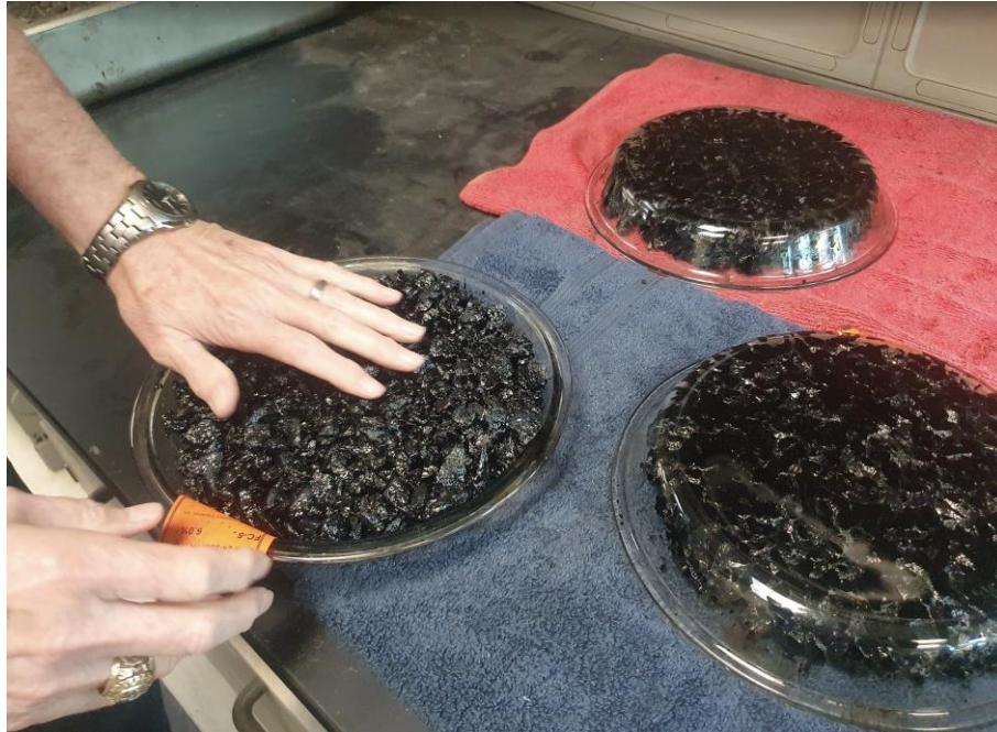
圖 31 SMO 試驗室 OGAC 最適含油量之派盤法操作情形
