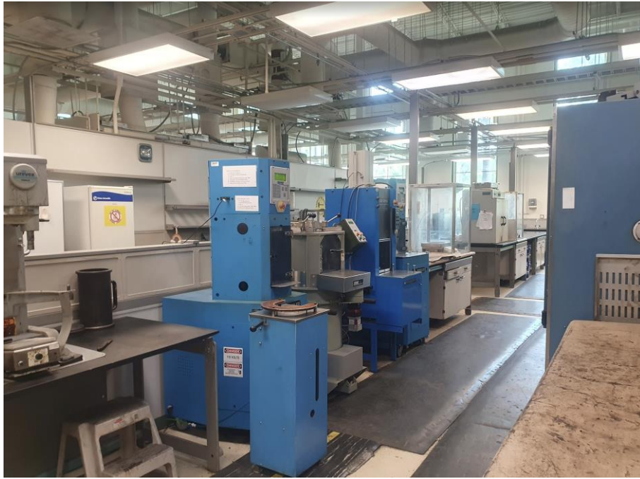
圖 45 SMO 試驗室的 SGC 設備(製作瀝青混凝土試體用)
