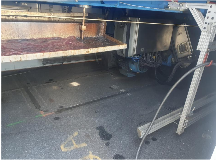
圖 51 其中一台 HVS 內部正在測試感應線圈修補方式
