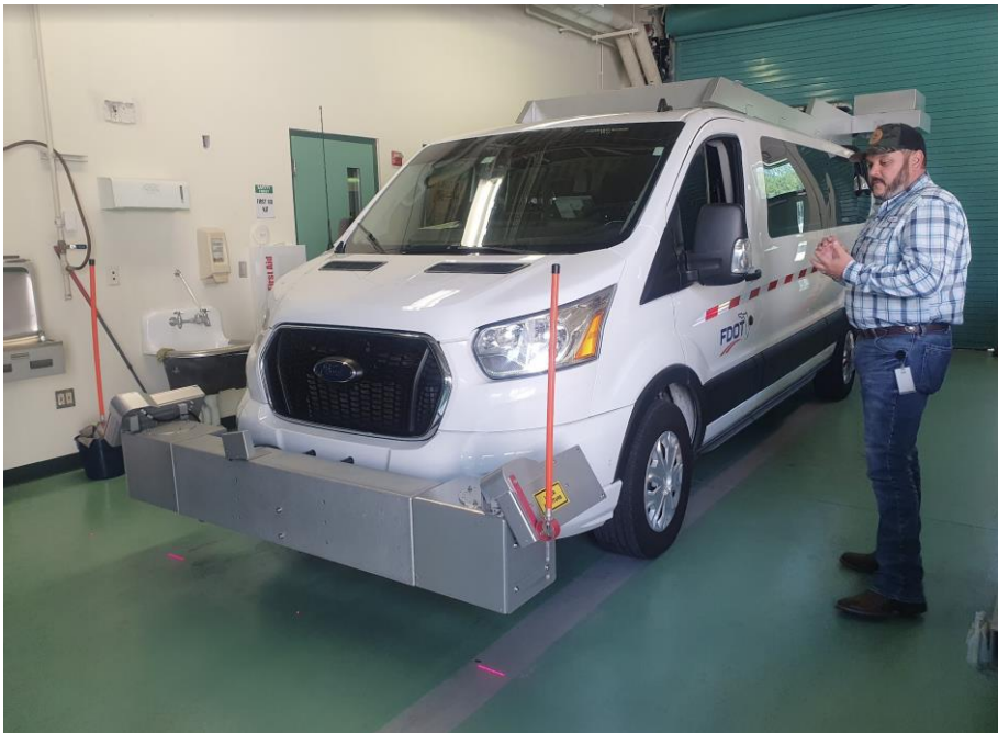
圖 38 LCSM 檢測車的前方的 IRI 雷射檢測設備
