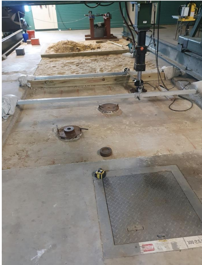
圖 48 SMO 試驗室路基試驗坑(test pit)
