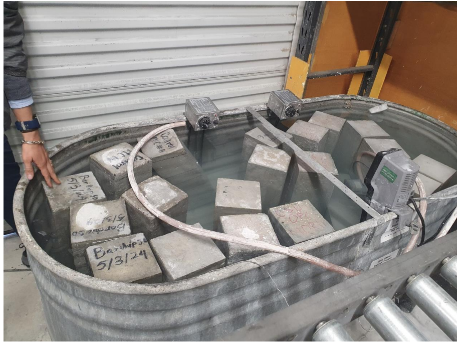
圖 65 養治中的長方柱狀試體
