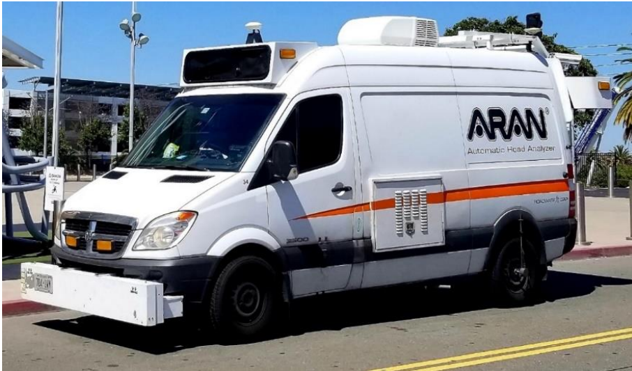
圖 24 Caltrans 的 ARAN 自動化檢測車(圖片來源：參考資料[10])
