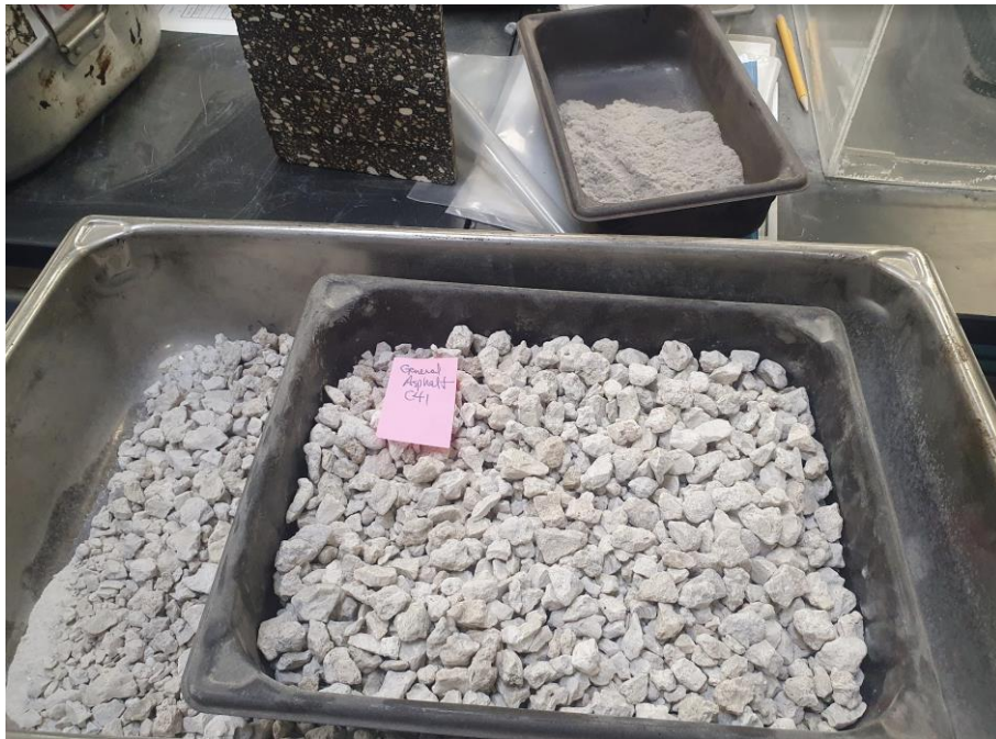
圖 42 試驗室內的石灰石路基樣品(裡面常能看到生物化石)
