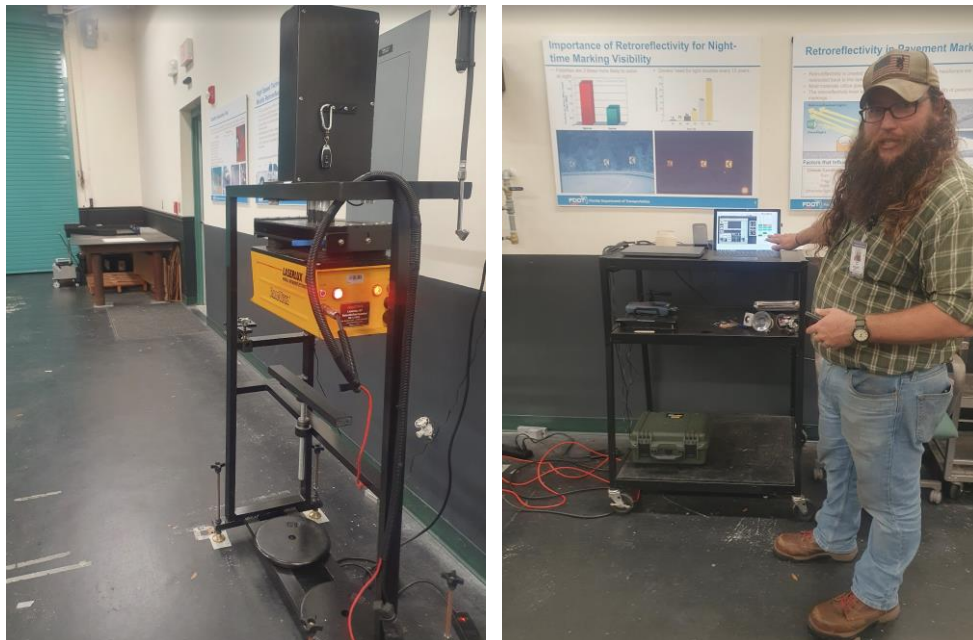
圖 41 SMO 自行開發用於模擬標線雨天反光度之設備 (左:檢測設備，右:讀取資料用的電腦)
