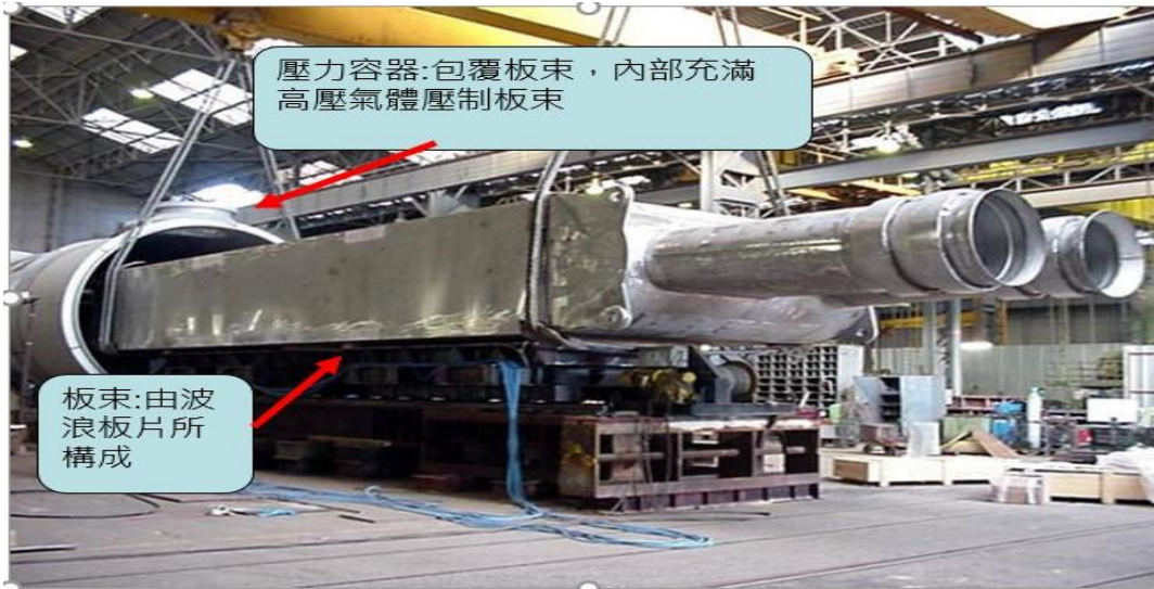
圖十、板式換熱器實際組合圖
