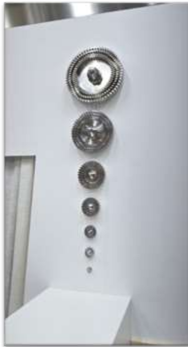
圖 9. DR-PB 設備中轉子-定子研磨器
