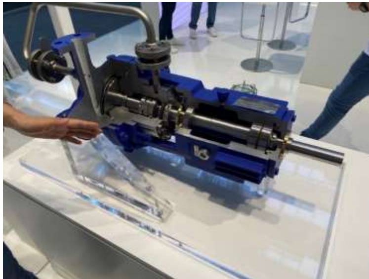
圖 6. AICHEMA 展場中 KSB 之 RPH 泵展示機
