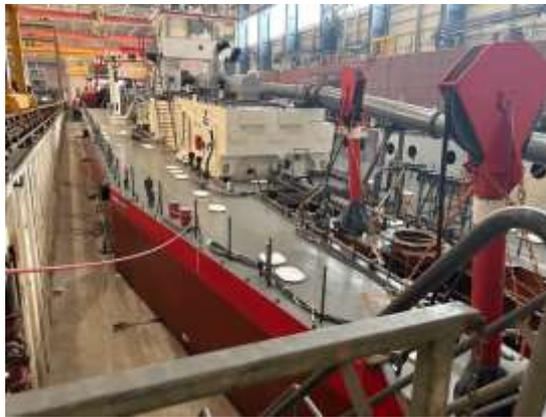
室內廠房耙吸式挖泥船 TSHD 製造
