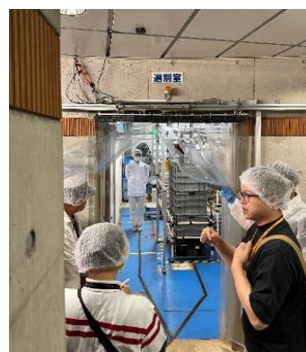
採收後生菜利用自動化磁線感應軌道搬運
