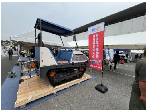
可附掛迴轉犁的履帶式電動曳引機
