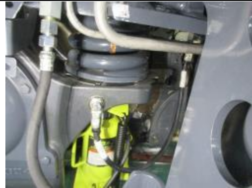
圖 6-10-20.將墊片置入底座下
