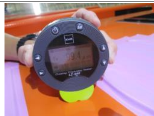
圖 3-9. 量測駕駛室結構膜厚不足
