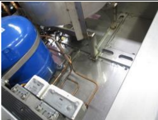
圖 4-11. 排水孔用膠帶密封
