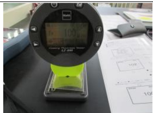
圖 3-2.以 100µm 測試卡校正
