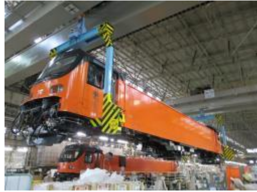
圖 6-10-4. 車身吊掛作業
