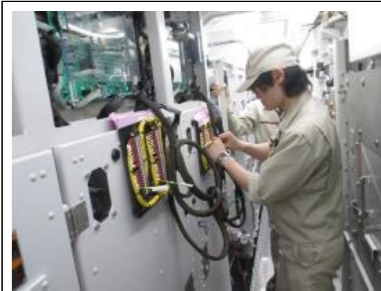
圖 6-3. 安裝測試治具
