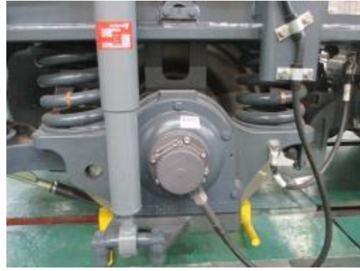
圖 6-5-3. ATP 轉速計及限速備援脈波產生器
