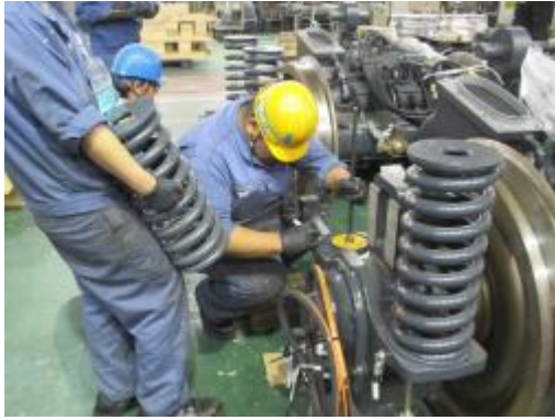
圖 6-10-9.確認墊片底座安裝方向
