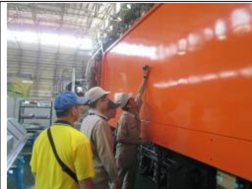
圖 3-5. 量測機械室側牆膜厚
