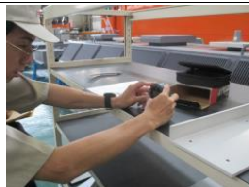
圖 3-1.檢測員執行膜厚計精度校正
