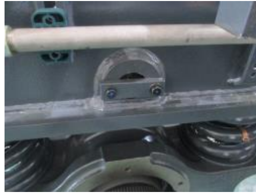
圖 6-1-14. 固定棒內、外側皆有安裝止擋片
