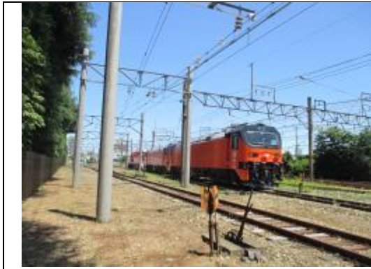
圖 1-1.將機車移動到有電區間
