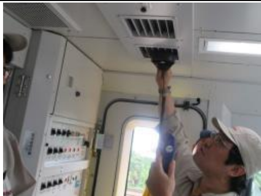
圖 4-4 於四個出風口正下方進行量測
