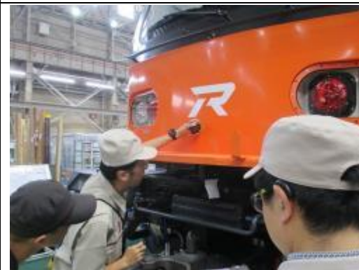
圖 3-7. 量測駕駛室結構膜厚
