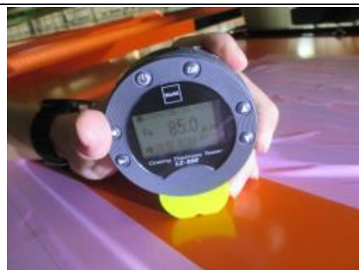
圖 3-10. 量測駕駛室結構膜厚不足
