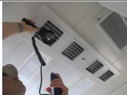
圖 4-5 於四個出風口正下方進行量測
