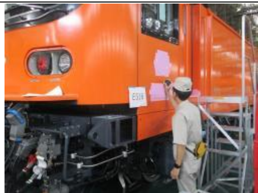
圖 3-8. 量測駕駛室結構膜厚
