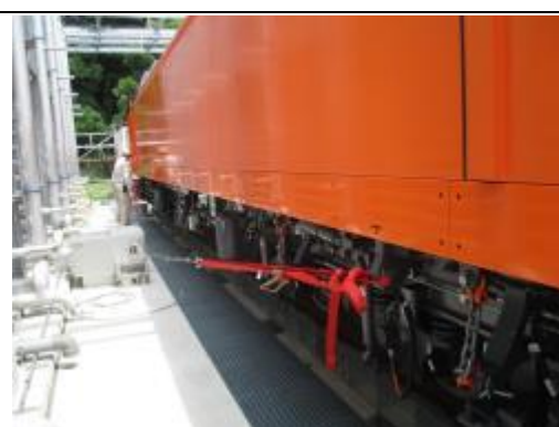
圖 2-2. 將絞盤的纜線與車輛兩端連結
