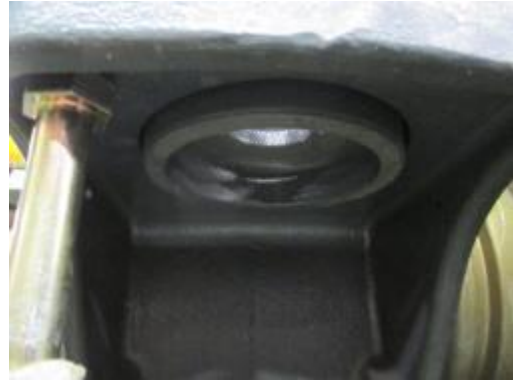
圖 6-10-10.正確安裝方向之墊片底座
