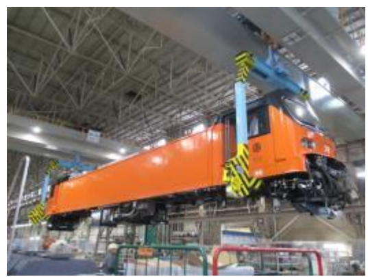
圖 6-9-4. 吊掛頂升作業
