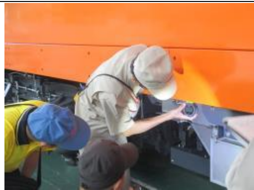
圖 3-6. 量測車架膜厚
