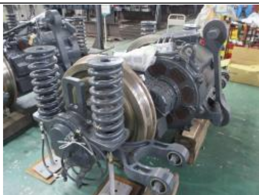
圖 6-10-7. 轉向架與輪軸組分離
