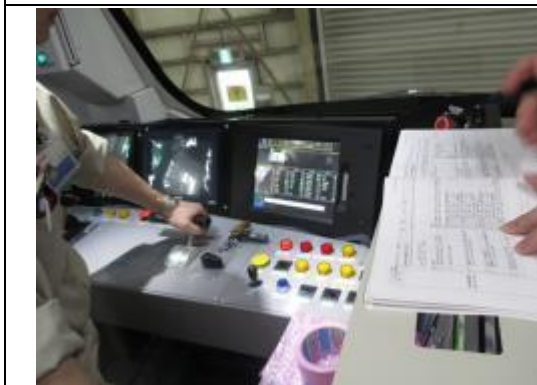
圖 5-3. 後退位出力測試
