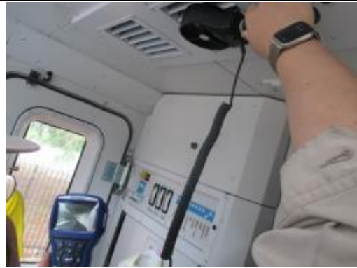
圖4-3於四個出風口正下方進行量測
