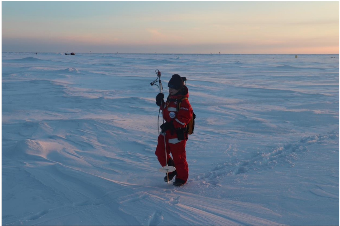
圖9 科學家背著儀器徒步行走在海冰上量測沿途海冰厚度。
