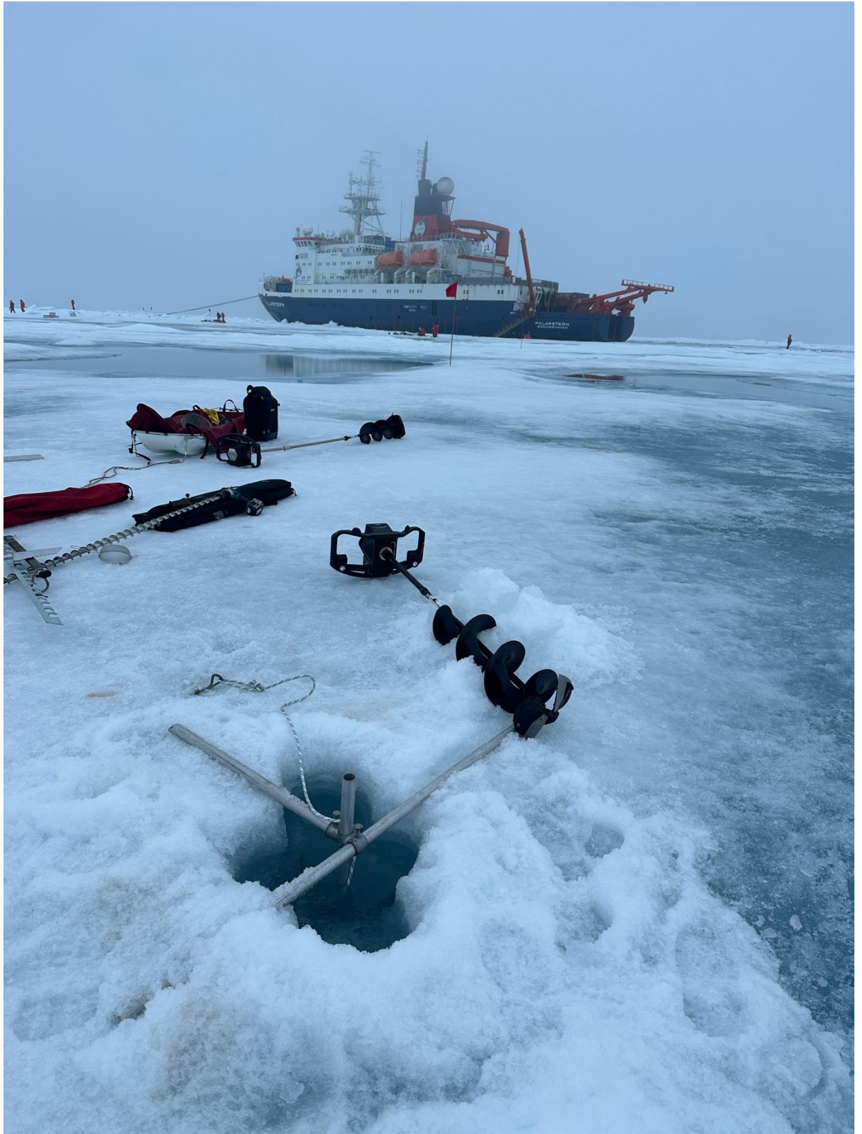
圖4 海冰作業測試站，在海冰上透過機具鑿洞以後將海流儀固定在鋁管架子向下量測海流垂直分布。
