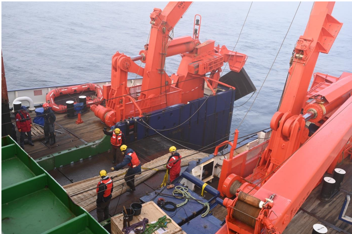
圖11 後甲板布放漁業拖網網具作業。
