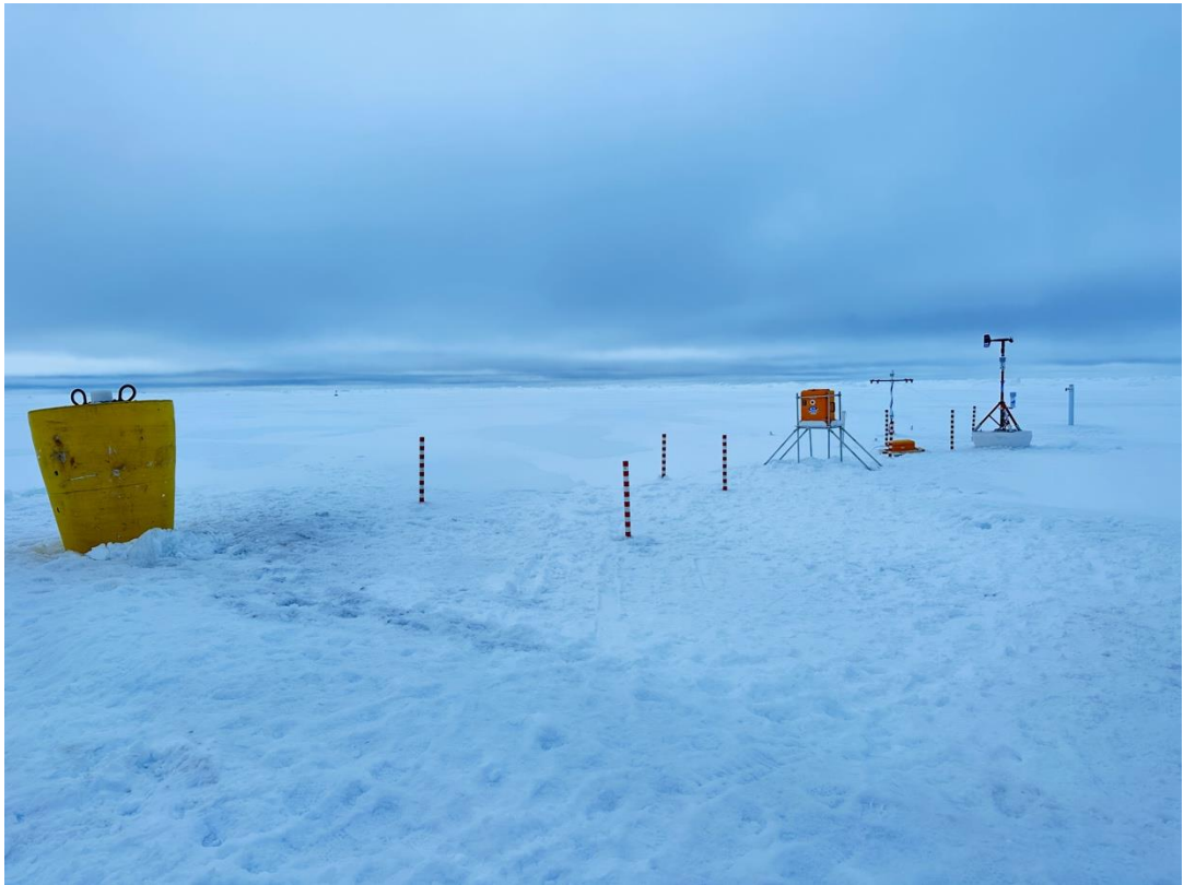
圖5 海冰上架設不同種類與大小的浮標觀測系統。
