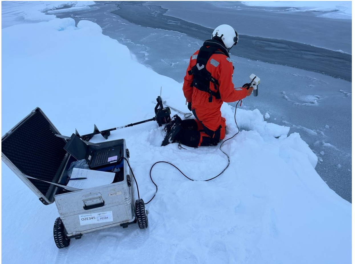
圖14 搭乘直升機至附近海冰上進行 XCTD 作業
