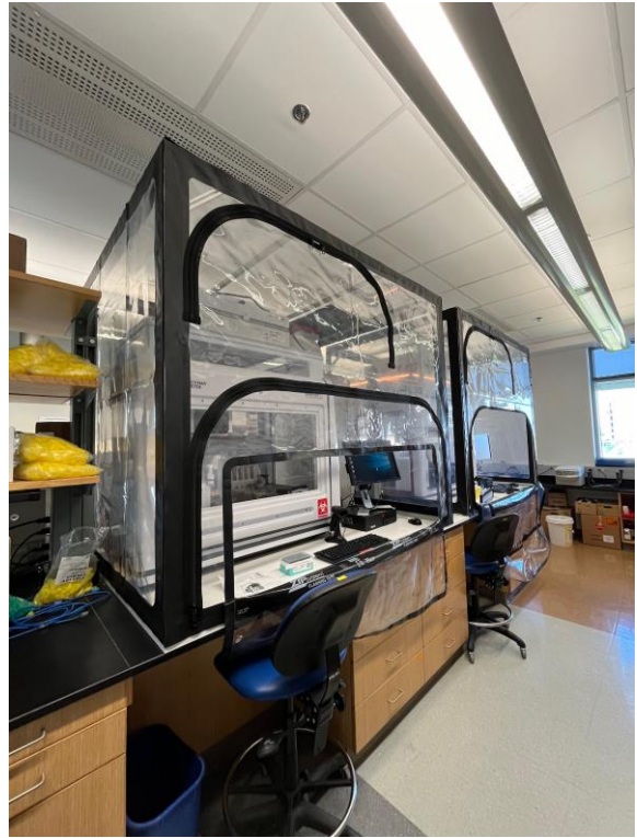
AHDC 分子診斷實驗室採用訂製保護罩，避免落塵汙染儀器設備
