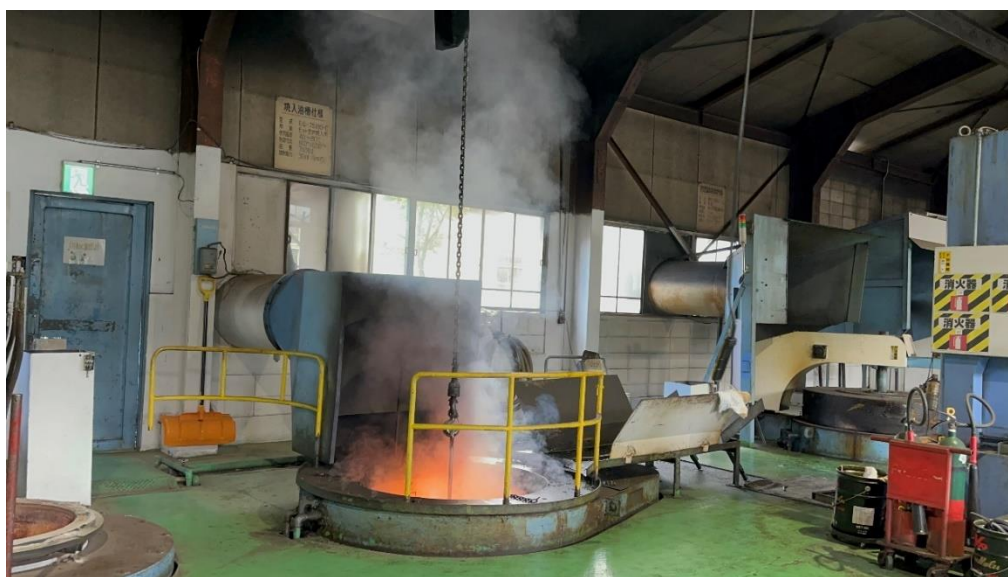
圖 7 特殊熱處理，強化鋼材強度
