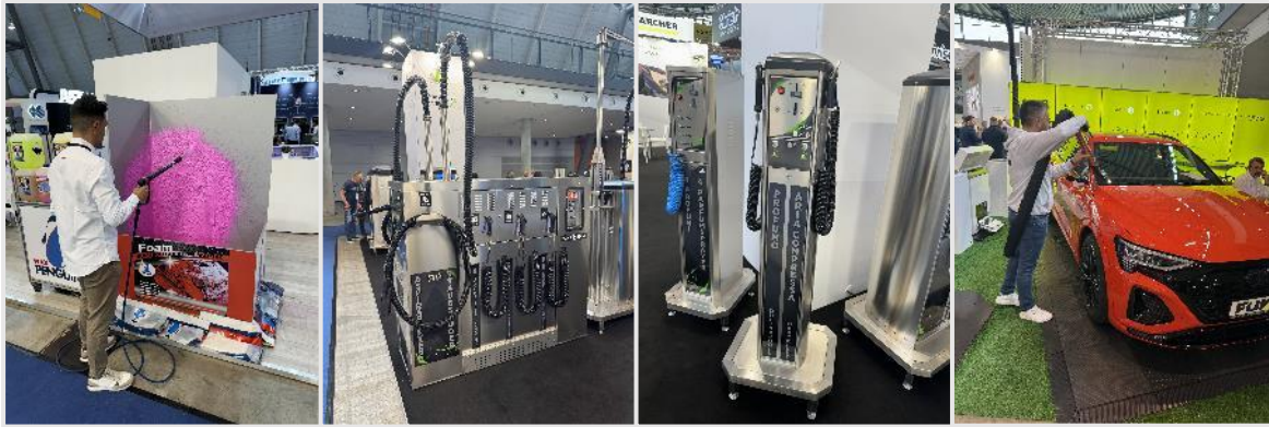
展覽現場亦有自助洗車相關設備，從左至右依序為泡沫噴槍、多功能自助洗車機、加水充氣機及自助高壓吹風機。
