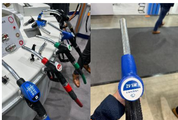
ELAFLEX 開發多款加油槍，功能皆有不同，且體積也越趨輕量化，右圖為兩刷水加注槍(僅有加注功能，無自動跳停)。
