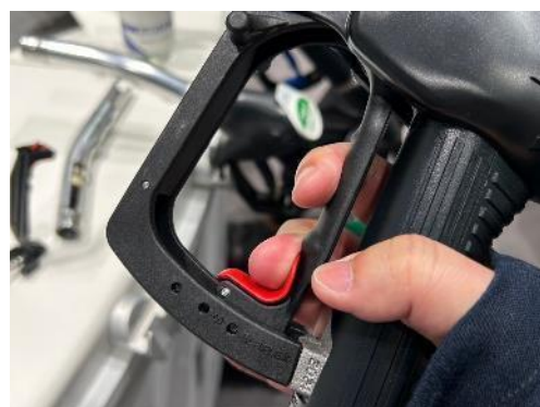
ELAFLEX 開發更便利的油槍板機維持裝置，在沒有板機門(檔板)情況下，加油能較為省力，亦適用於自助加油。
