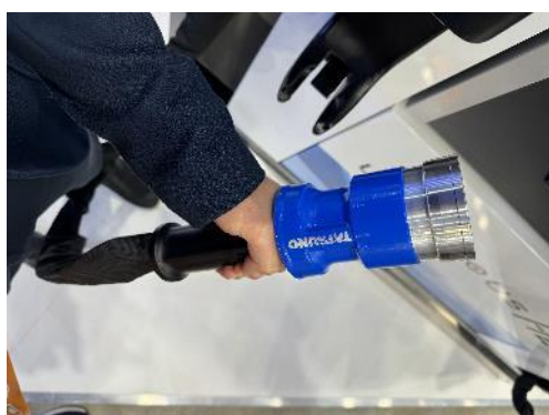
TATSUNO 品牌加氫機之加氫槍型式，其特點為加注過程無須注意方向性，且免設置萬向接頭。
