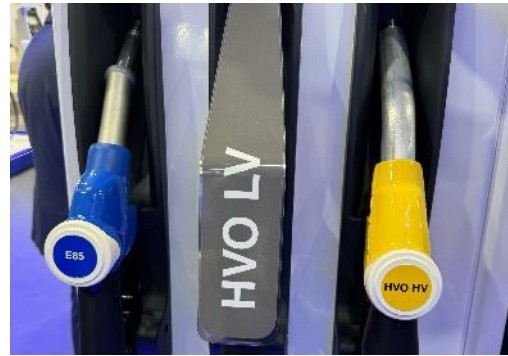
此款加油槍設有油槍上蓋，除較為美觀外，亦可提醒加油員或顧客使用油品別。
