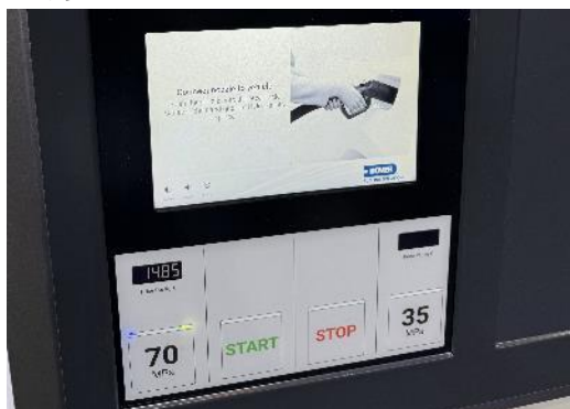
Dover 品牌加氫機設置多媒體螢幕，顯示加氫流程供顧客參考。
