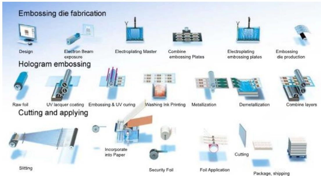
圖 43 箔膜生產流程示意圖
