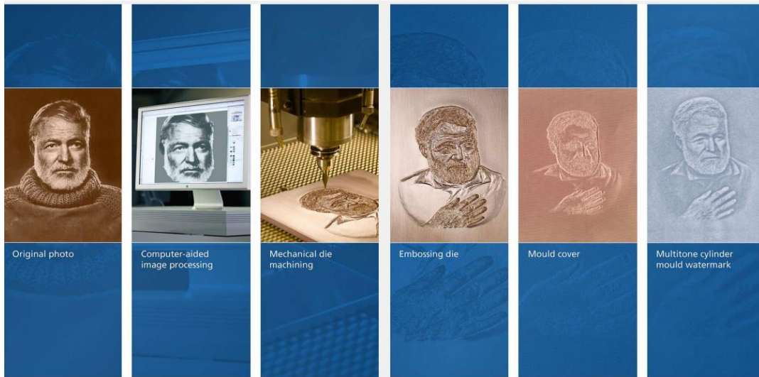
圖 38 水印圖像製作流程示意圖
