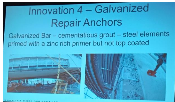
(12) 採用鍍鋅修復錨座
