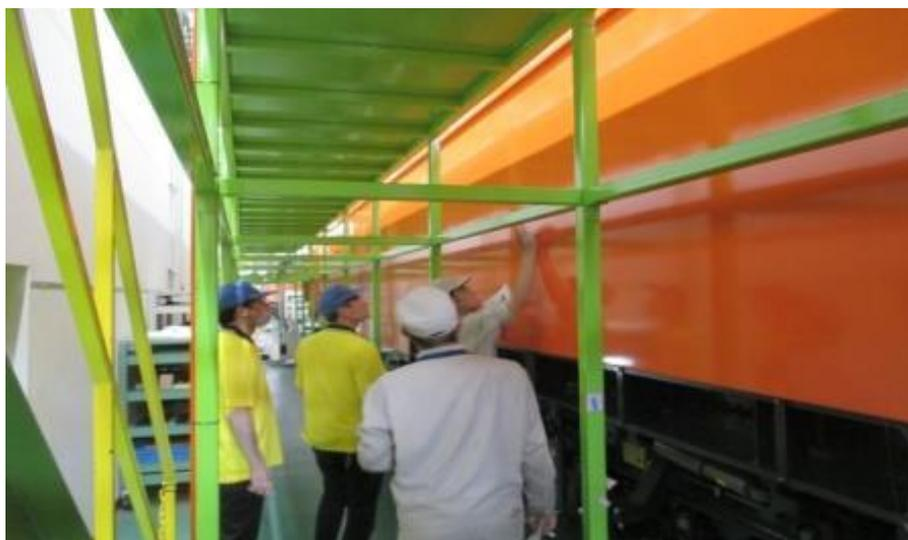
圖 3-6-5 機械室側牆膜厚量測
