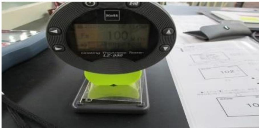
圖 3-6-1 配合校正塊確認精度
