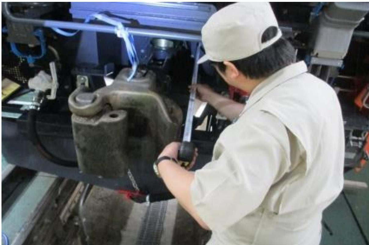
圖 3-9-4 連結器長度量測
