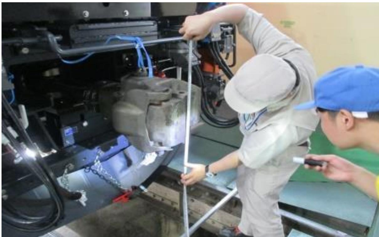
圖 3-9-3 連結器高度量測
