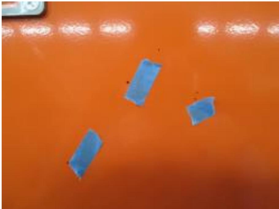
圖 3-6-8 瑕疵部份用膠帶標記再作處理
