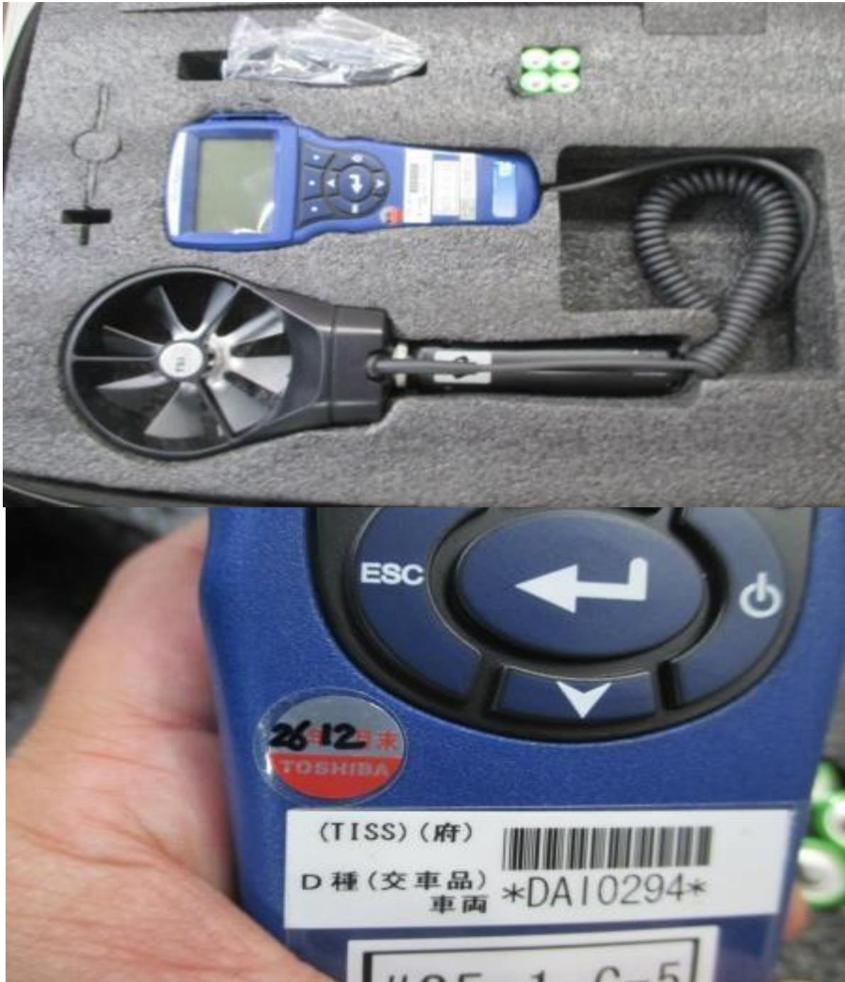
圖 3-1-2 檢視量測儀器校正使用期限
