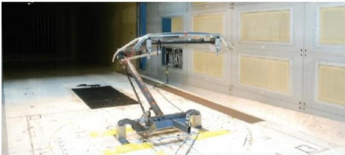
圖 6-4-2 集電弓風洞試驗
