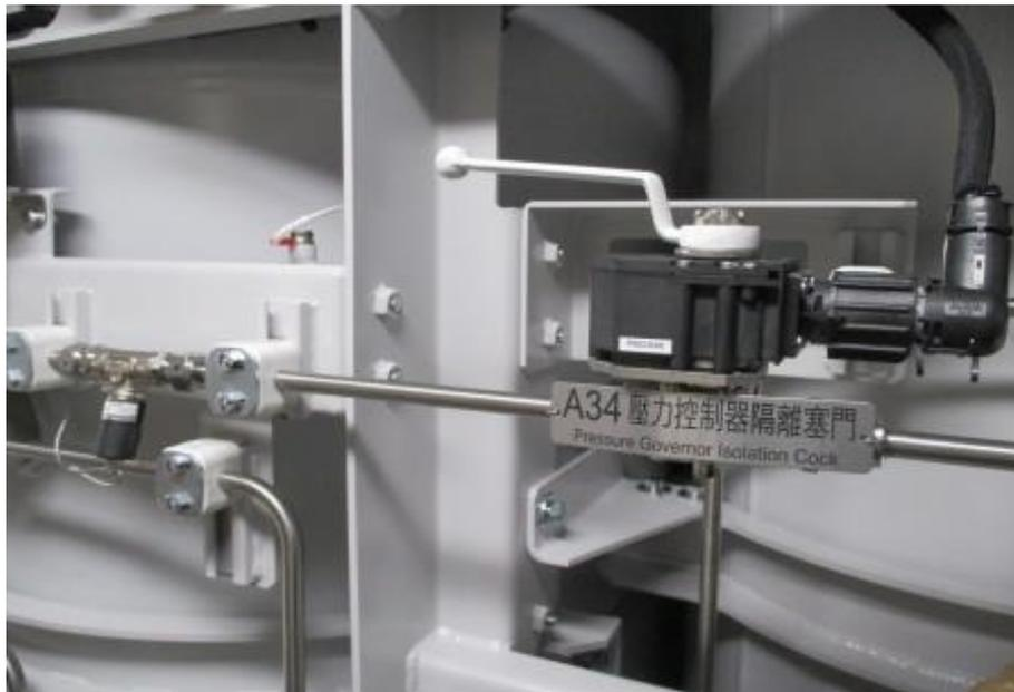
圖 3-3-1 關閉壓力控制器隔離塞門
