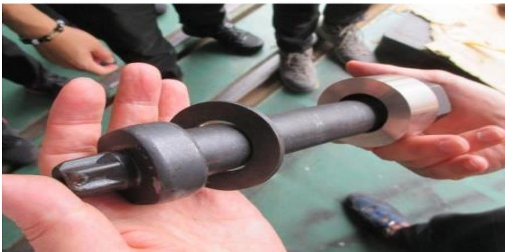
圖 3-11-2 使用特殊螺絲鎖固限制扭力
