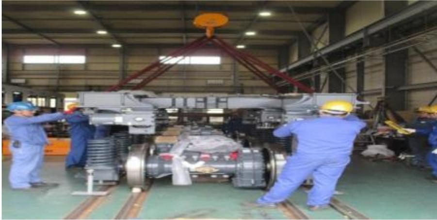
圖 3-11-3 將轉個架掛至各車軸關達上
