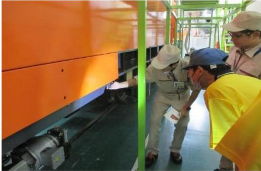
圖 3-6-7 車架膜厚量測
