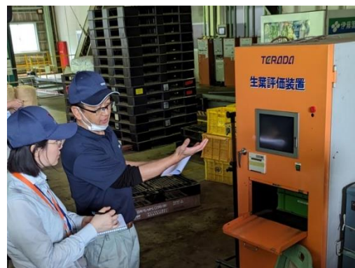
圖 4、寺田製作所解說人員在介紹茶菁檢測設備，可快速檢測茶菁水分及纖維素含量
