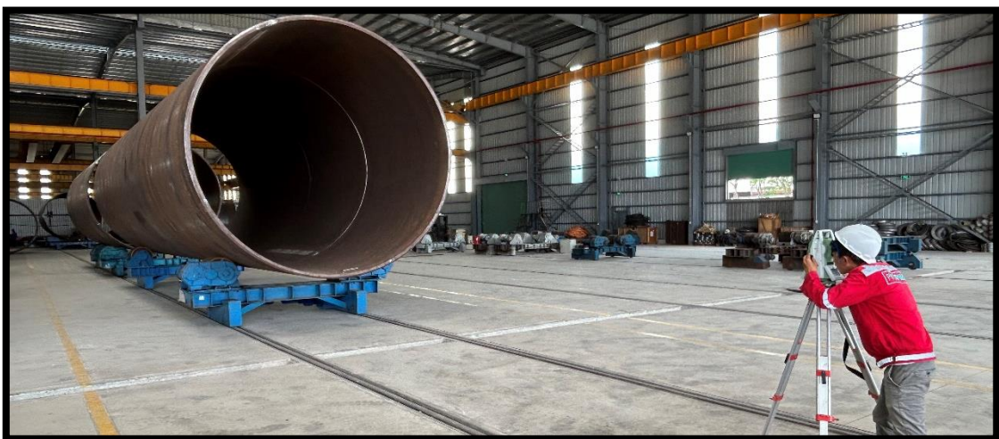
圖 35 本案海上變電站下部結構鋼管進行真圓度測試
