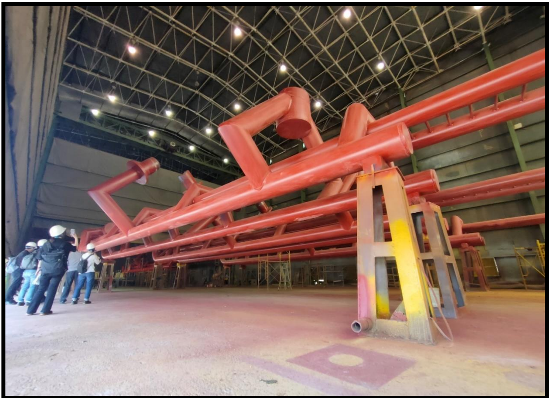
圖 15 船靠系統(階段性塗層完成)
