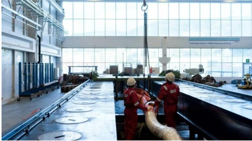
圖二十五、Bergen 中心的大型船纜繩強度試驗<sup>[5]</sup>
