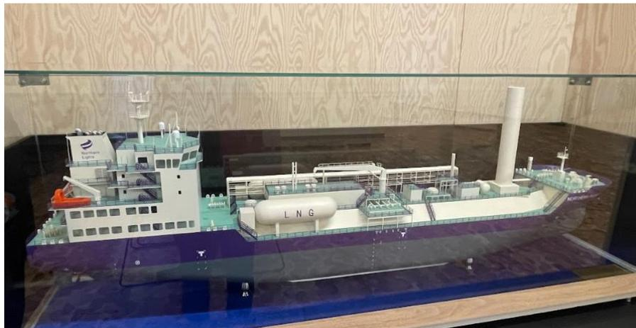
圖四、Northern Lights 計畫內所設計的液態二氧化碳運輸船模型
