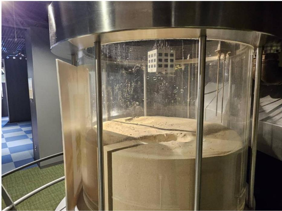
圖 42、小型地震土壤液化展示模型
