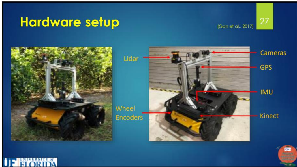
圖 2-4 無人地面車輛的自主導航系統
