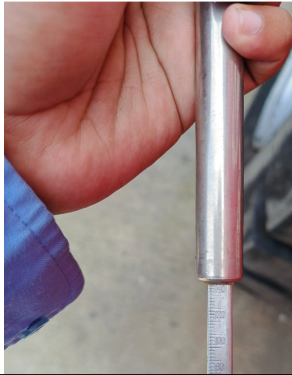
機具檢修及測試胎壓是否正常
