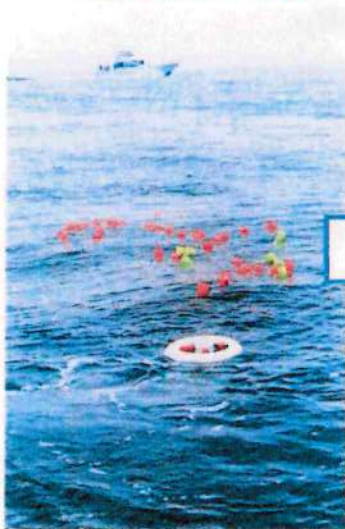
自作ドリフター、市販ドリフター 電磁流速計での検証
