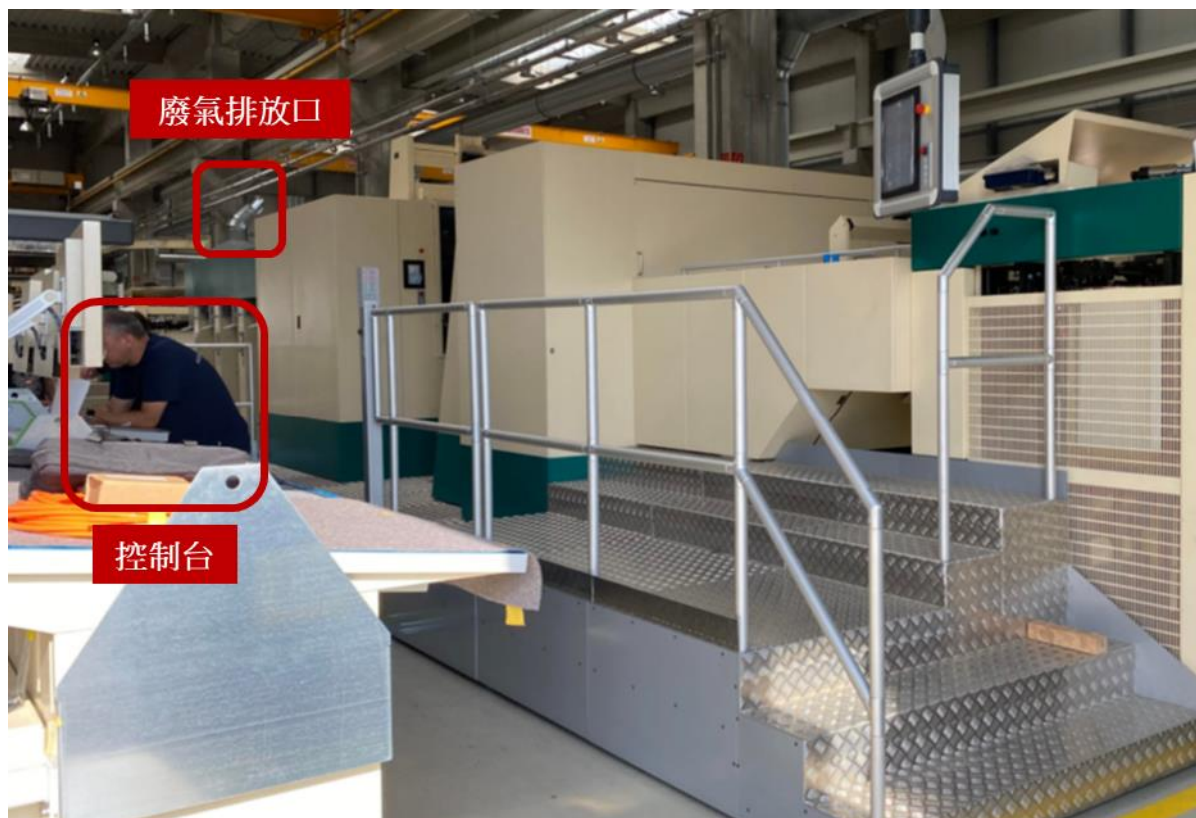
圖 16、大張檢查號碼印刷機 VOCs 濃度測試示意圖
