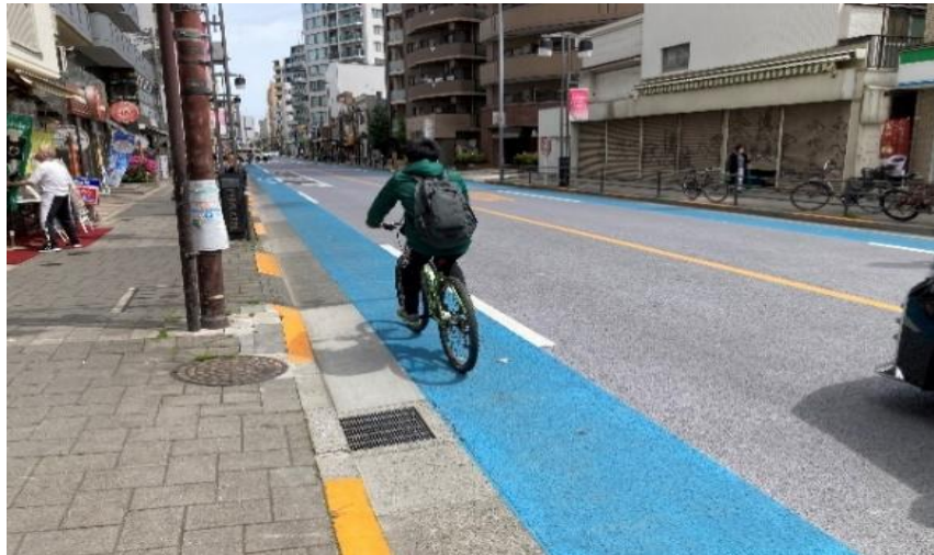
圖 2.58 透水性瀝青鋪面範例-用於自行車道(摘自 Nichireki 參訪簡報)
