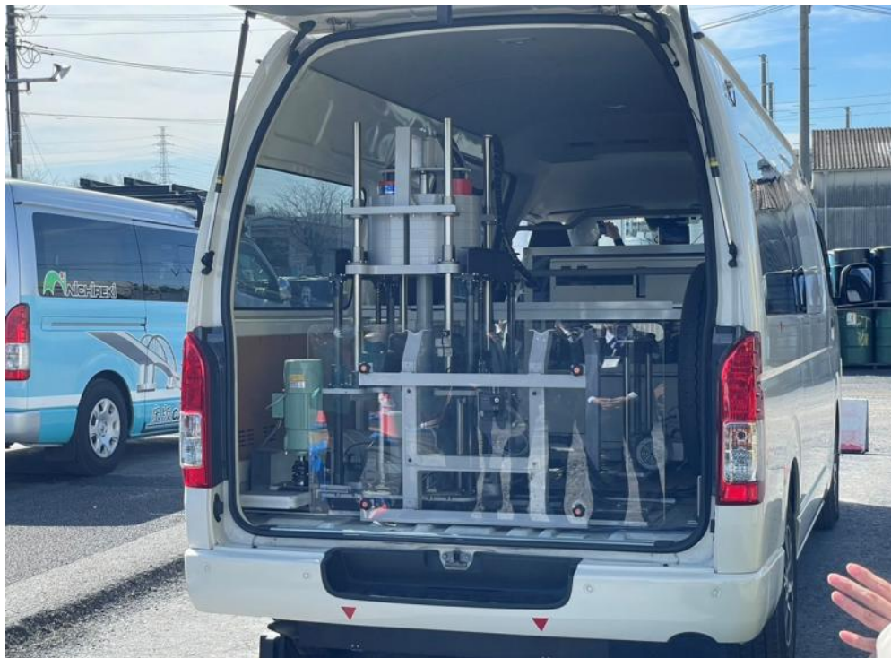
圖 2.48 鋪面撓度檢測-FWD 簡介與現場參訪照片(Nichireki 簡報資料及協助攝影)
