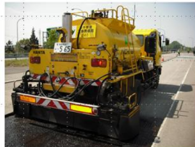
圖 2.47 層間黏結材料(黏層)簡介(摘自 Nichireki 參訪簡報)
