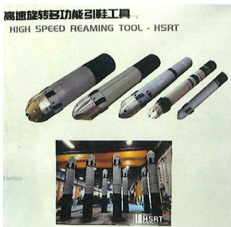
高速旋轉多功能引鞋工具（HSRT）是一種高溫高壓的多用途工具，水力驅動轉速能達 3000 轉/分鐘。能夠與連管配合，高速完成井下通刮洗的作業；可用於下套管作業，帶領套管高速順利通過不穩定地層。
