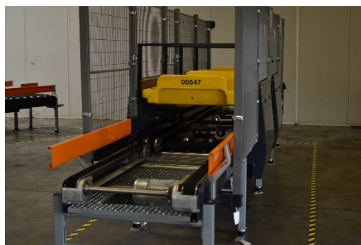
圖 27 堆疊機/拆疊機
