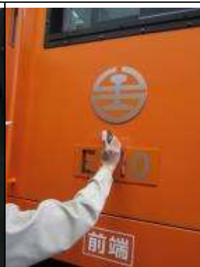
圖 11-15:駕駛室結構漆膜測量點 8
