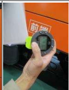
圖 11-16:駕駛室結構漆膜測量值
