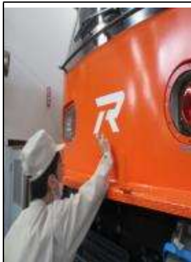
圖 11-13:駕駛室結構漆膜測量點 7
