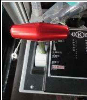
圖 12-10:操作 EBV 並將自動司軔閥把手置於「全緊軔位」
