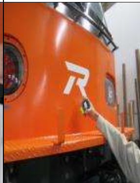
圖 11-19:駕駛室結構漆膜測量點 10
