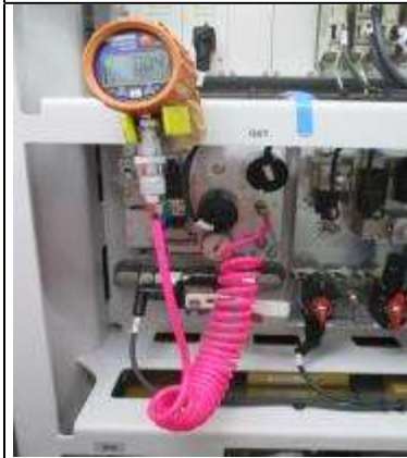
圖 12-4: 將壓力表接入BP 監控測試接頭(U43.15)
