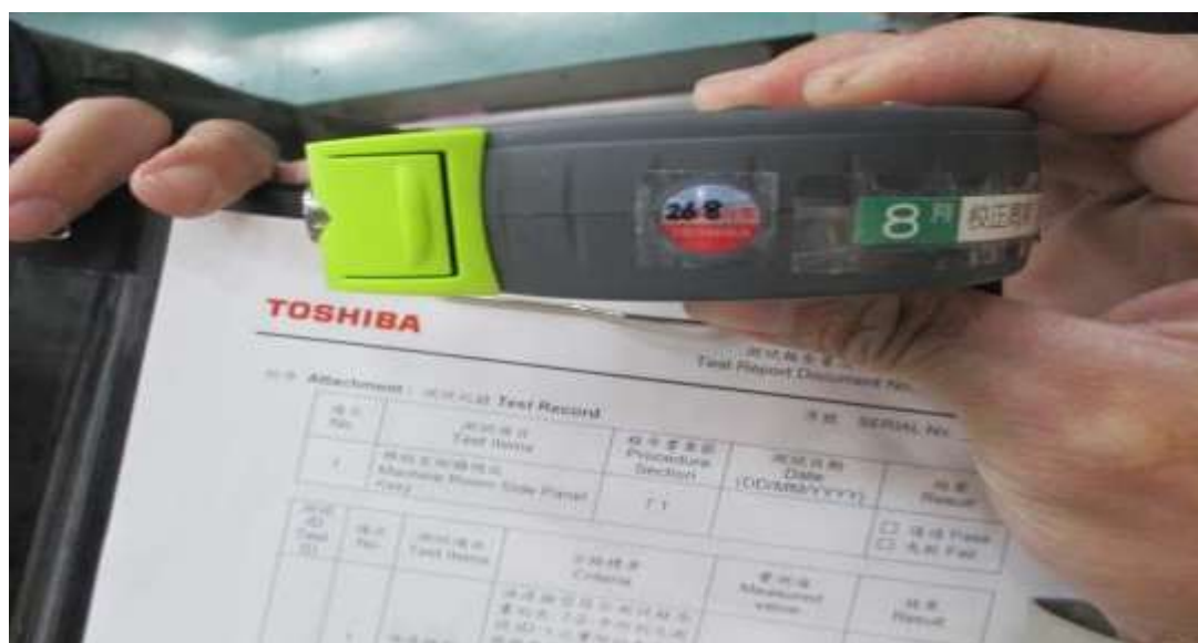
圖10:檢視膜厚計校正日期
