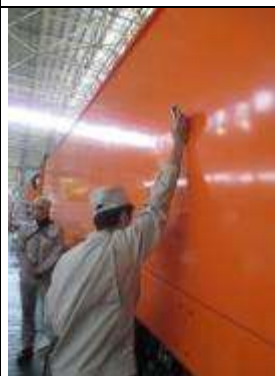
圖 11-11:機械室側 牆總成漆膜測量點 6
