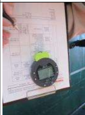
圖 11-10:機械室側 牆總成漆膜測量值
