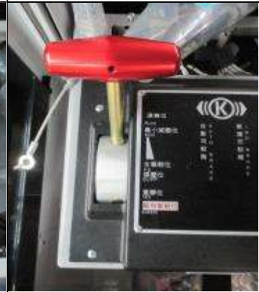
圖 12-6: 操作 EBV 並將自動司軔閥把手置於「運轉位」
