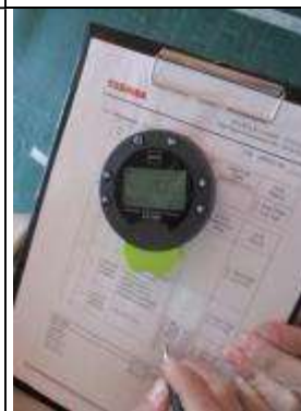
圖 11-8:機械室側 牆總成漆膜測量值
