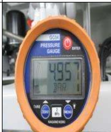
圖 12-8: 確認 BP 已充氣至 5.0 \pm 0.21 bar
