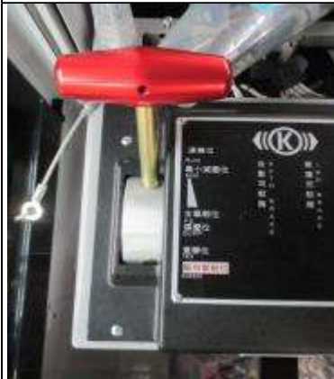
圖 12-13:操作 EBV 並將自動司軔閥把手置「運轉位」。
