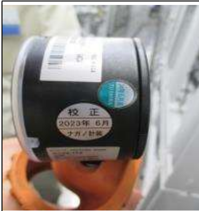
圖 12-1: 檢視數位壓力錶校正日期
