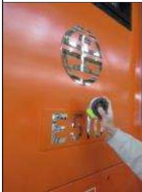
圖 11-17:駕駛室結構漆膜測量點 9
