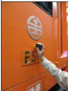
圖 11-21:駕駛室結構漆膜測量點 11
