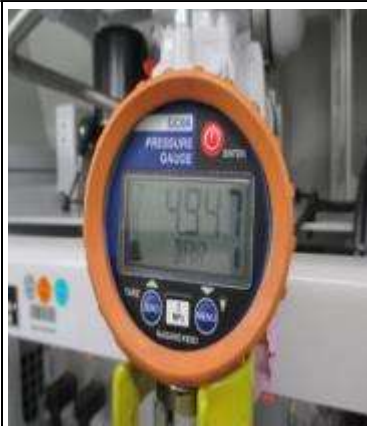
圖 12-11:用碼表開始計時一分鐘,確認 BP 壓力洩漏小於 0.4 bar /分
