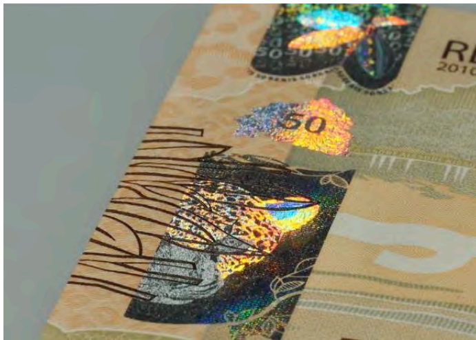
圖 126 CLASSIC partial metallization
