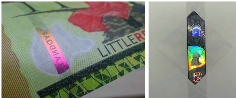
圖 87 開窗結合安全線或光影變化箔膜的設計範例
