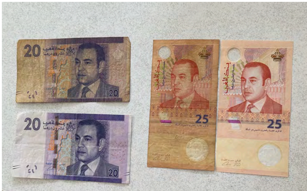
圖 99 右圖為 Durasafe®塑膠夾層鈔券紙，流通了 12 年的狀況優於左邊用棉質紙印製的鈔券。
