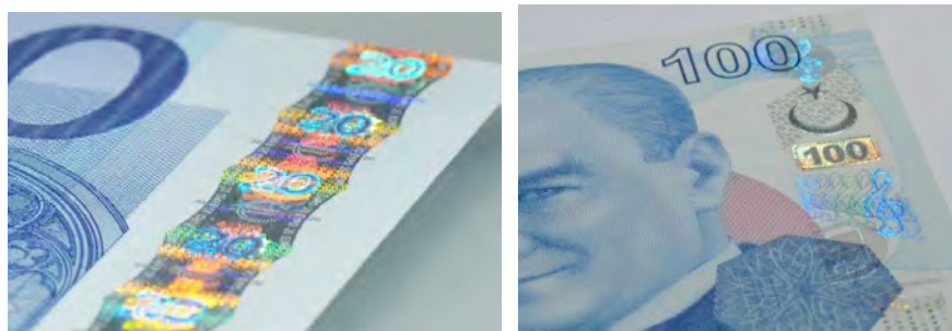
圖 120 左圖為不定位 OVD，右圖則為定位。
