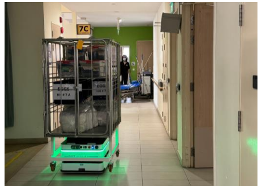
自動搬運車可以自動運送物品
