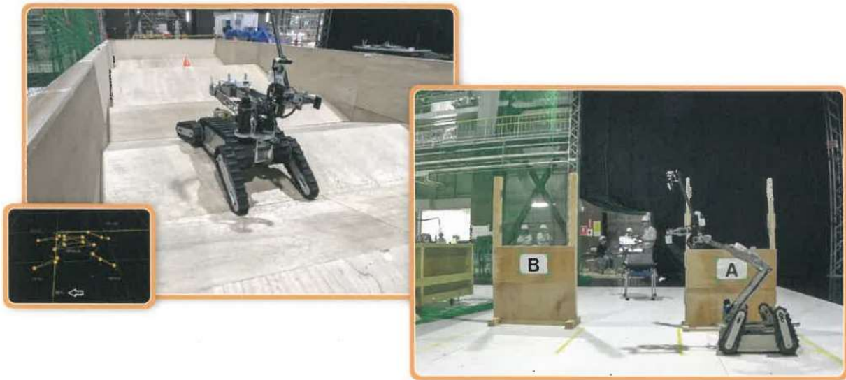
圖 39 遠距機器人模擬爬梯及機械手臂作業
