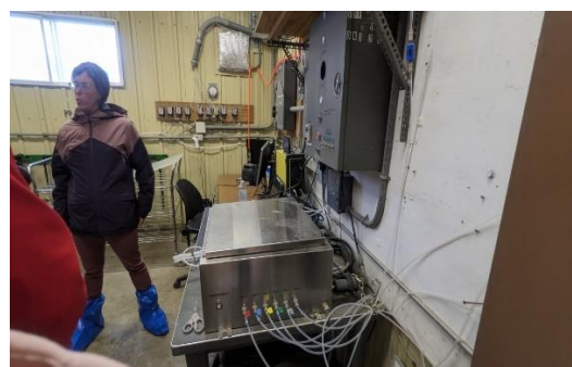
圖 21. 美國農業部乳牛芻料研究中心 Dr. Lizzy French 介紹試驗乳牛場使用之呼吸室後端連結的收集系統
