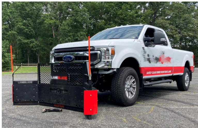
圖 3-2 可迅速將散落物或障礙物推移至路側之設備
