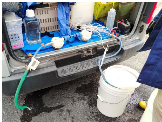
圖 14 現場過濾 20 公升之水樣
