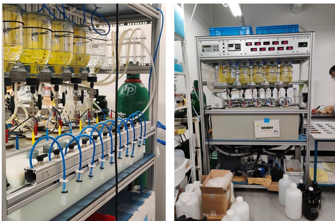
圖 37 電解濃縮設備
