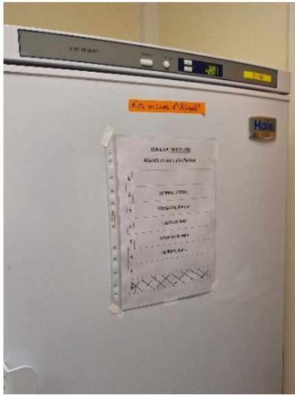
圖三十一、分子診斷試劑保存於-20°C 冰箱，並於冰箱上標示保存對應位置。
