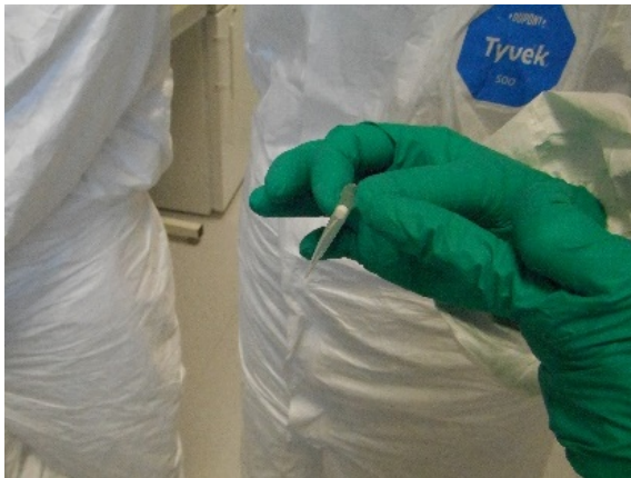
圖二十九、分子診斷試驗使用具 filter 的微量吸管尖操作避免汙染。
