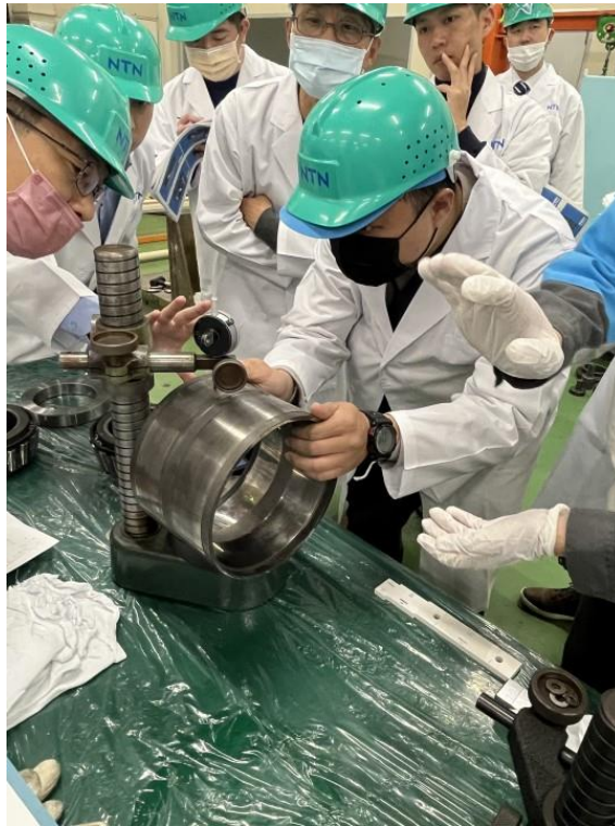
圖 12 軸承外徑尺寸量測操作
