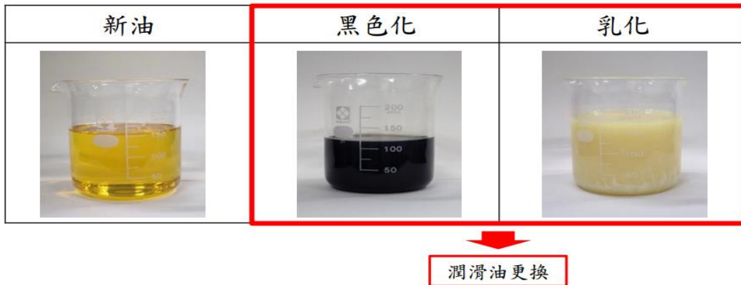
圖 89 潤滑油劣化確認
