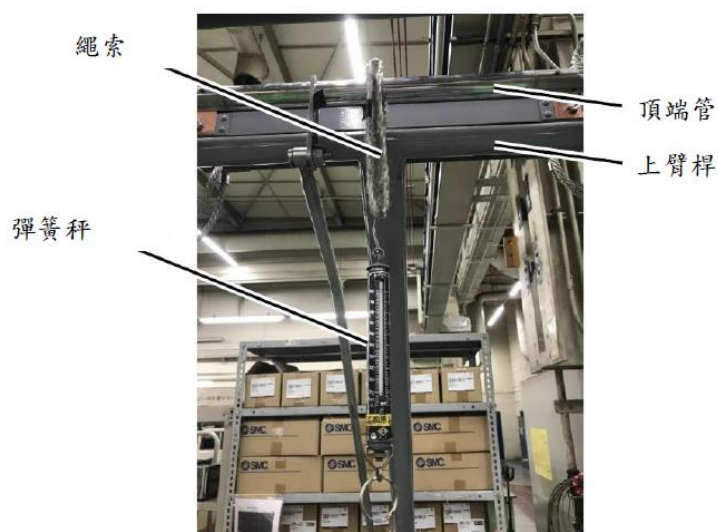
圖 50 他案集電弓測量示意圖
