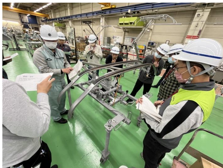
圖 15 集電弓裝置實機確認
