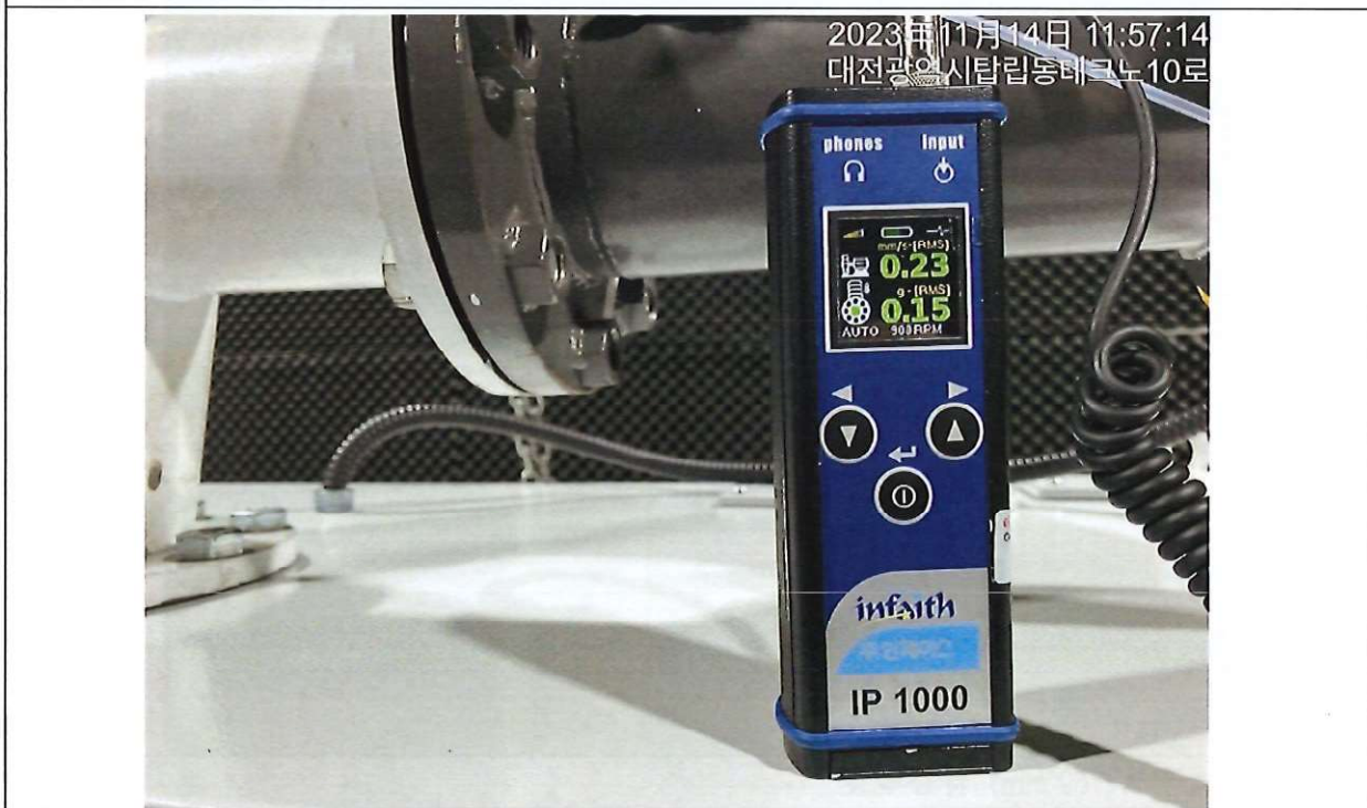
震動值: 0.23mm/sec 符合規定
