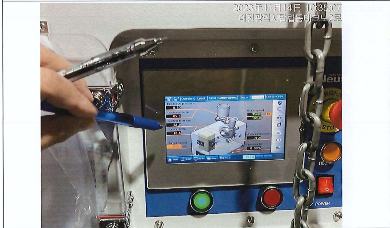
量測最大風量 52.9m 3 /min 符合規定
