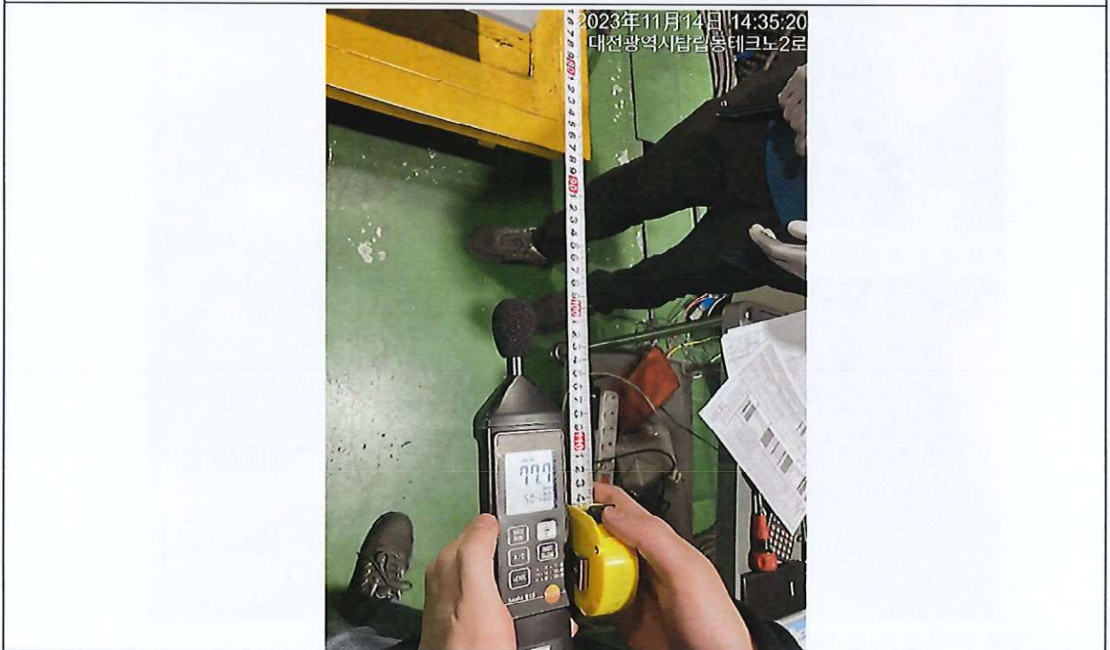
測試運轉中噪音距離 1m 處，第一點 77.7 分貝 符合規定
