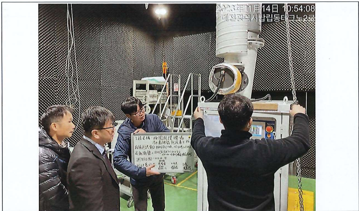
查驗設備尺寸 W(769 mm) 符合規定
