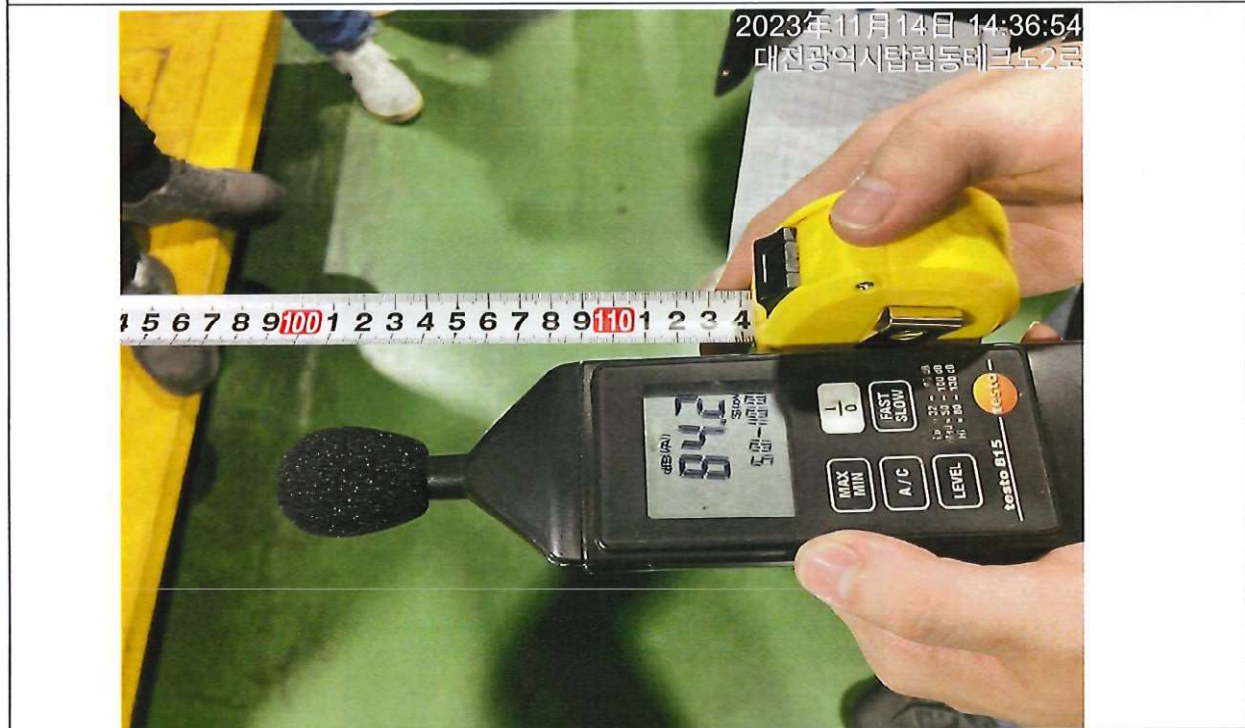
測試運轉中噪音距離 1m 處，第二點 84.2 分貝 符合規定
