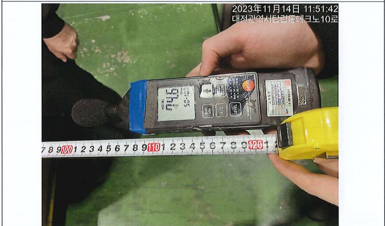
測試運轉中噪音距離 1m 處，第一點 74.6 分貝 符合規定
