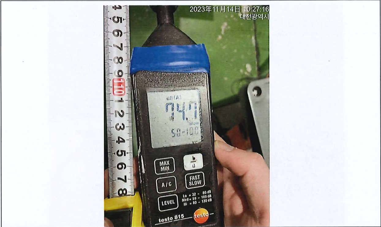
測試運轉中噪音距離 1m 處，第二點 74.7 分貝 符合規定
