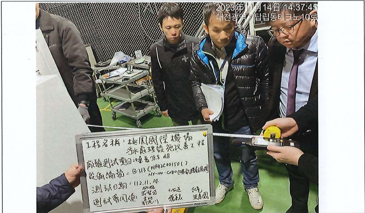
測試運轉中噪音距離 1m 處，第三點 78.8 分貝 符合規定
