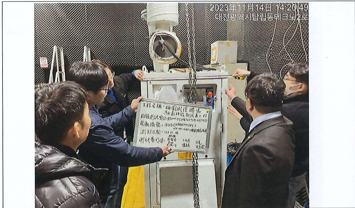
查驗設備尺寸 W(769 mm) 符合規定
