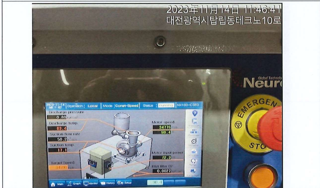
運轉測試額定風壓及風量時轉速為 34776rpm 符合規定
