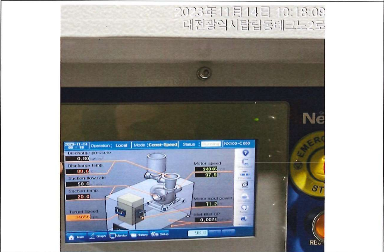
運轉測試額定風壓及風量時轉速為 34846rpm 符合規定
