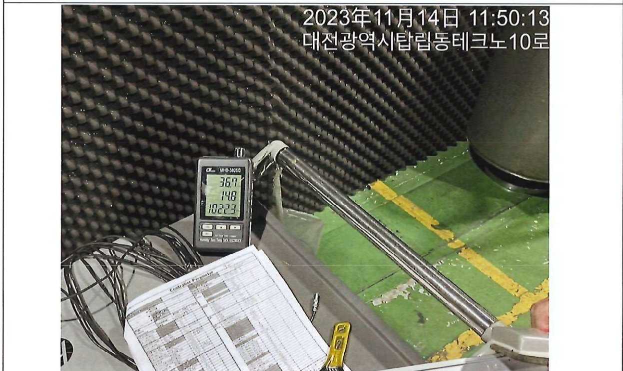
測試環境溫度: 溫度°C 14.8、壓力 atm 1(1024 gw/cm 2 )1022.3、相對溼度 RH% 36.7 符合規定
