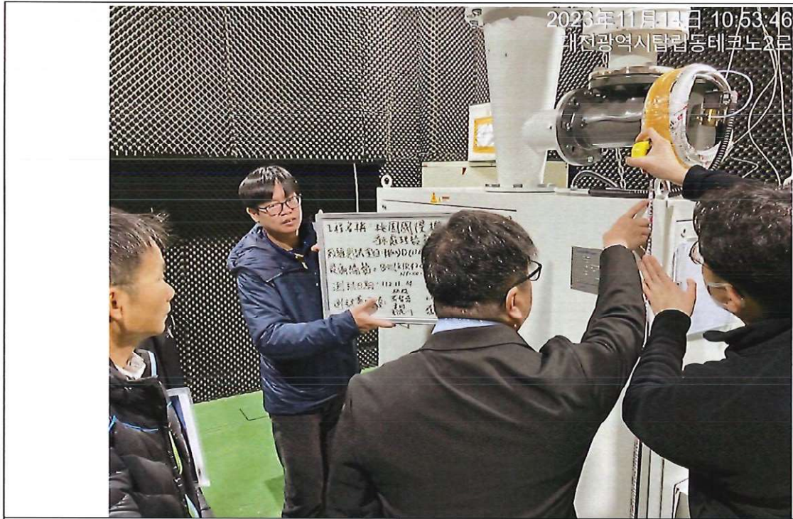
查驗設備尺寸 H(1349 mm) 符合規定 ✓
