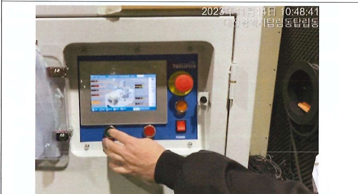
測試單一按鈕啟動運轉正常 符合規定 本測試為動態畫面詳光碟 B311 單一按鈕啟動
