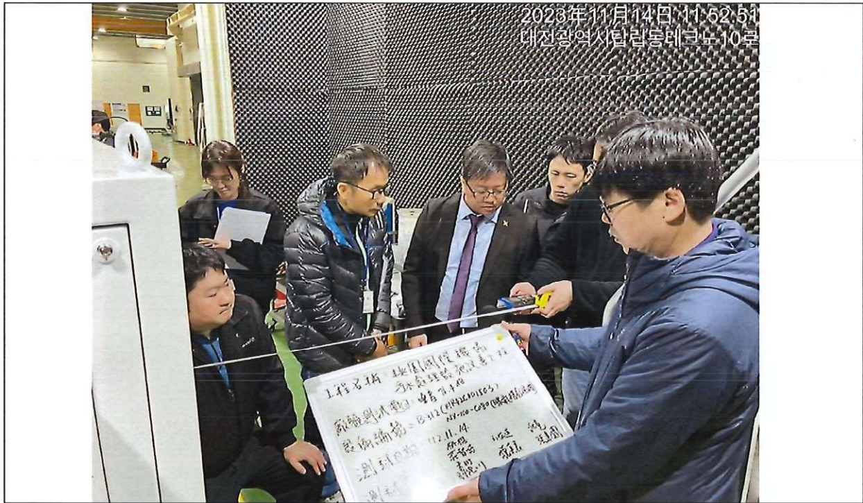
測試運轉中噪音距離 1m 處，第二點 76.4 分貝 符合規定
