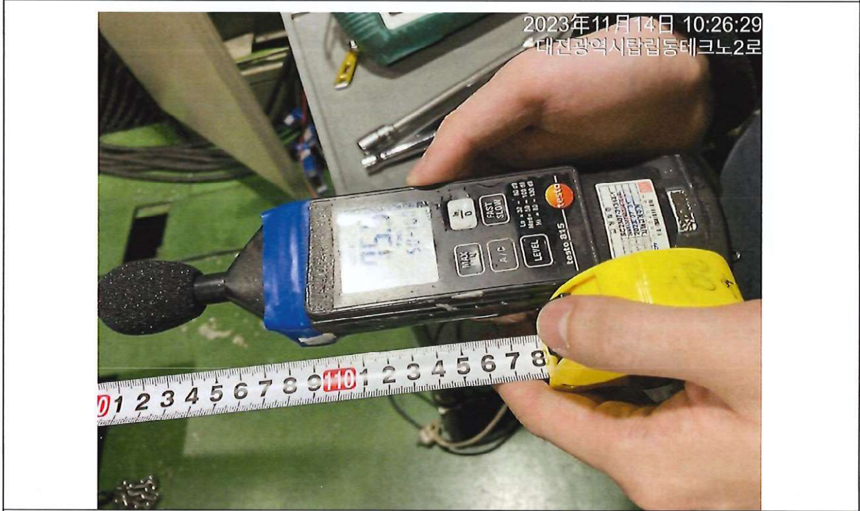
測試運轉中噪音距離 1m 處，第一點 75 分貝 符合規定
