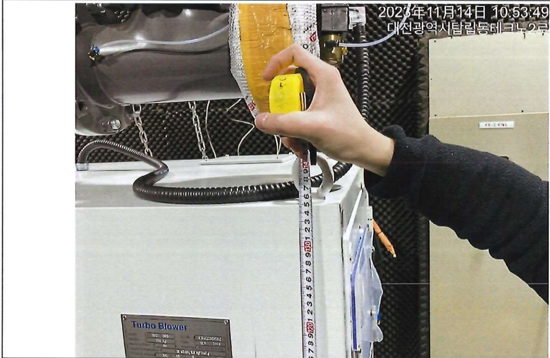
查驗設備尺寸 H(1349mm) 符合規定 ✓
