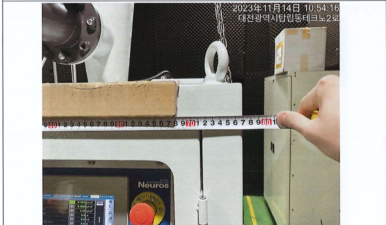
查驗設備尺寸 W(769 mm) 符合規定
