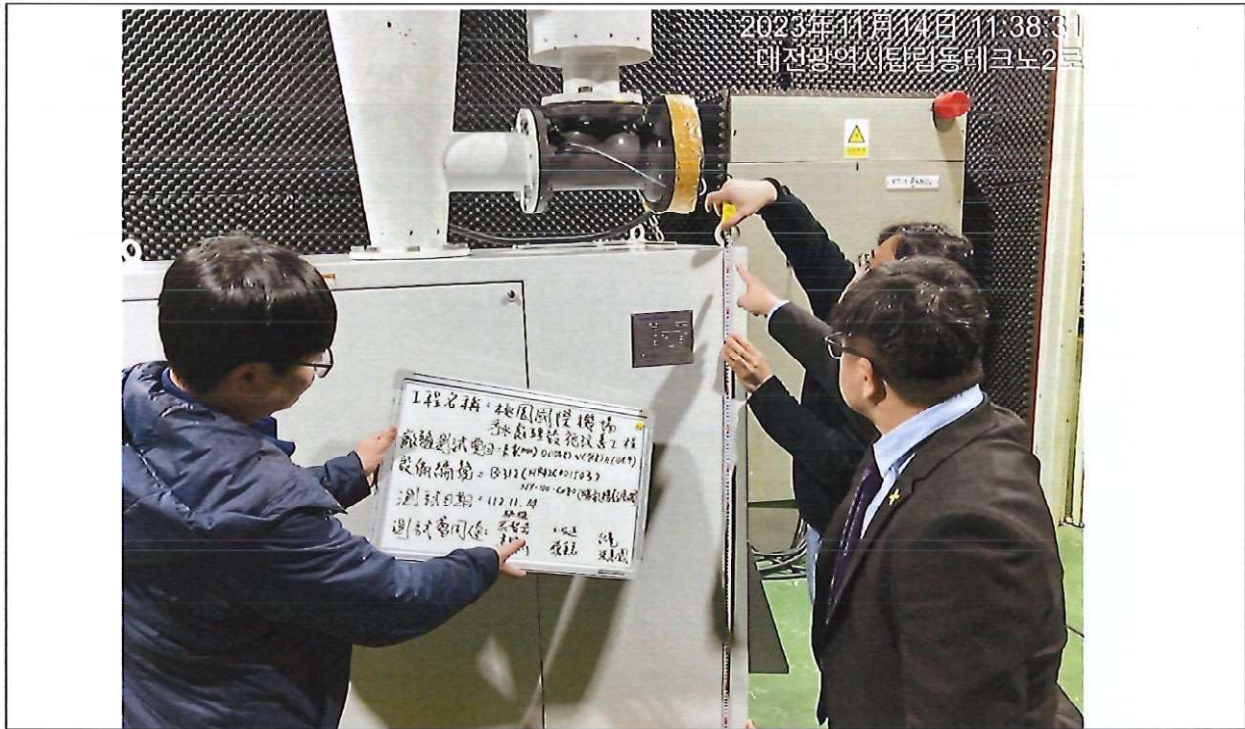
查驗設備尺寸 H(1349 mm) 符合規定
