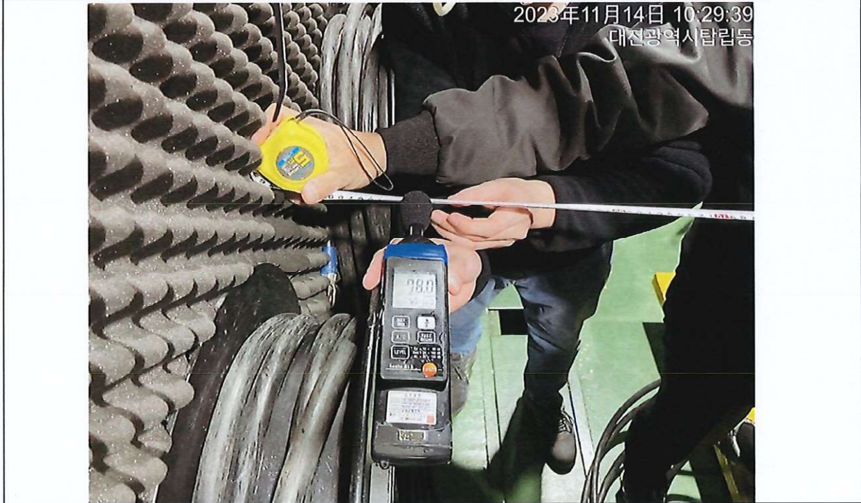
測試運轉中噪音距離 1m 處，第三點 78.0 分貝 符合規定
