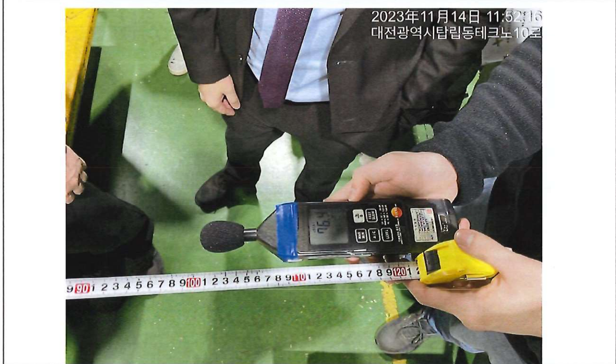
測試運轉中噪音距離 1m 處，第二點 76.4 分貝 符合規定
