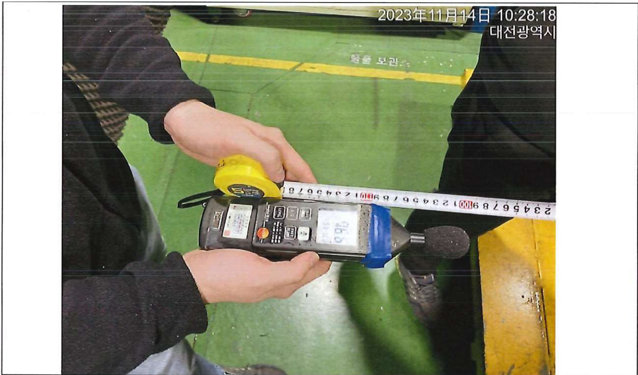
測試運轉中噪音距離 1m 處，第四點 76.6 分貝 符合規定
