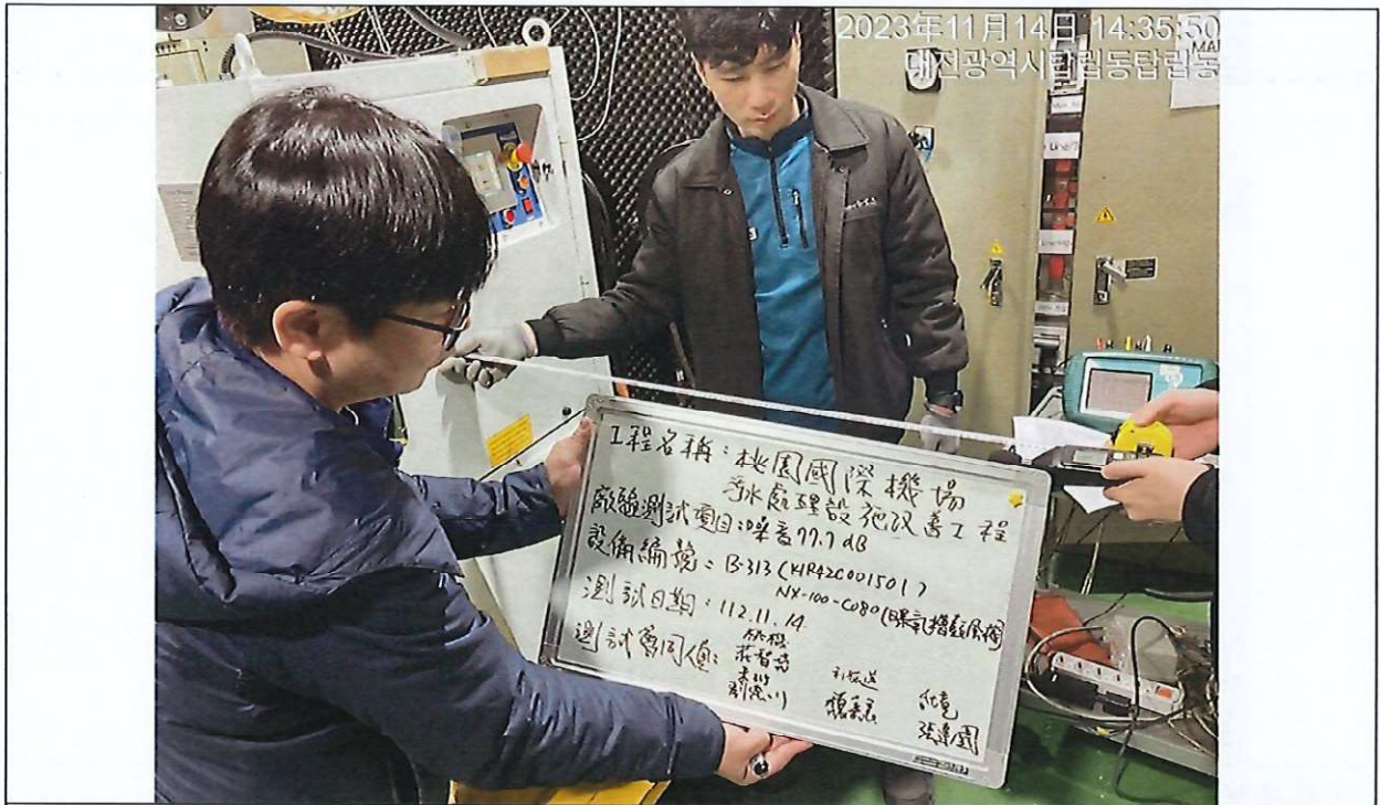
測試運轉中噪音距離 1m 處噪音值不大於 85 分貝
