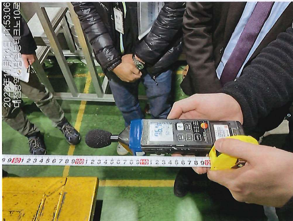
測試運轉中噪音距離 1m 處，第三點 76.4 分貝 符合規定
