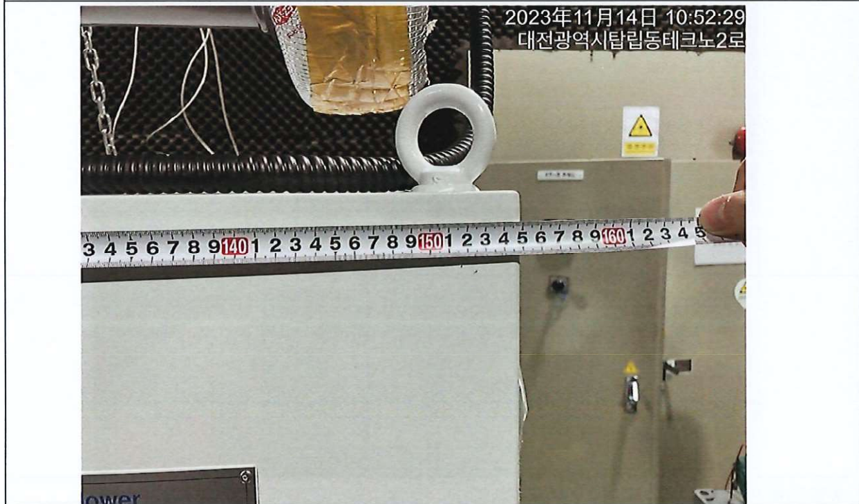
查驗設備尺寸 D(1548 mm) 符合規定
