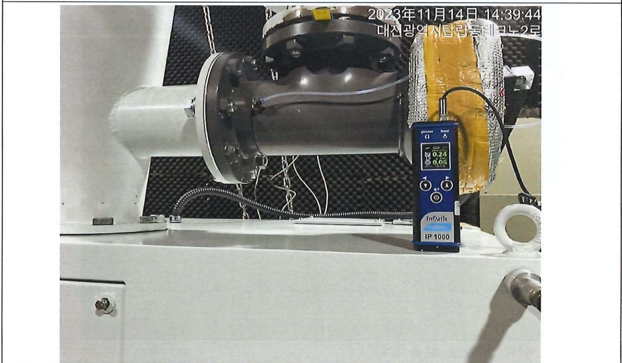
震動值: 0.24mm/sec 符合規定
