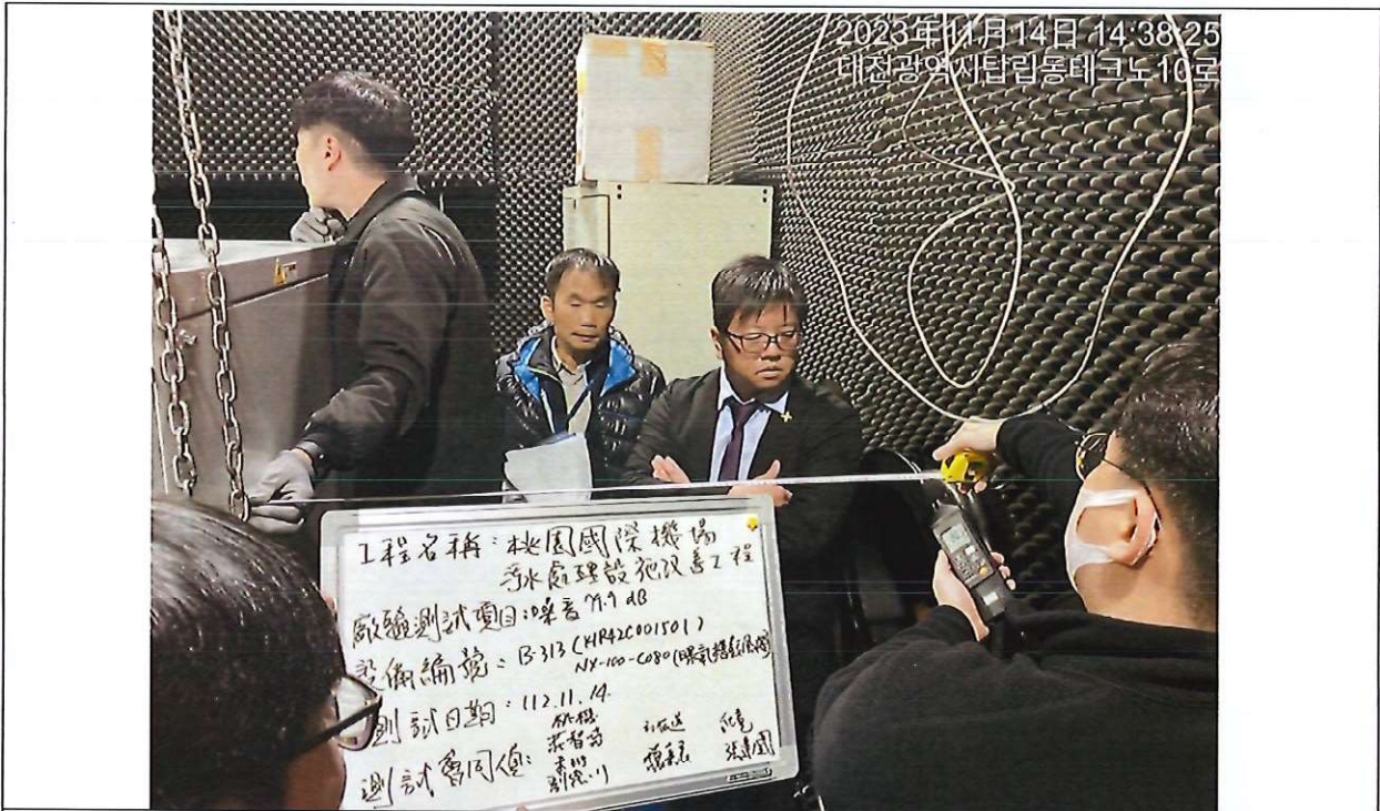
測試運轉中噪音距離 1m 處，第四點 79.9 分貝 符合規定
