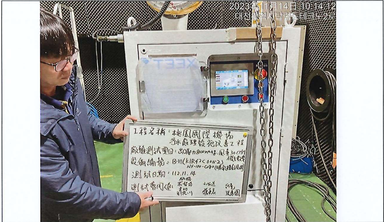
運轉測試: 出口壓力 8000mmaq 風量 30m 3 /min 不發生激變
