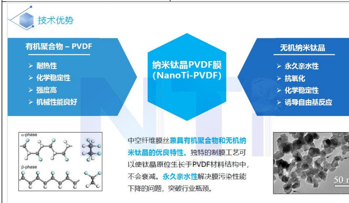
圖33 奈米鈦晶 PVDF 膜為鈦晶於 PVDF 載體之原位長晶技術
