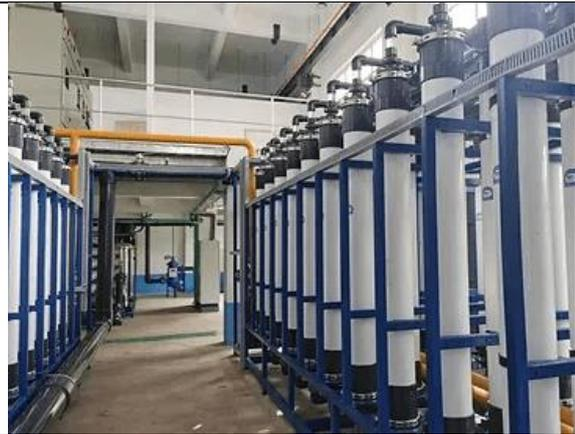
圖11 3E memtech 低壓納濾中空纖維膜
