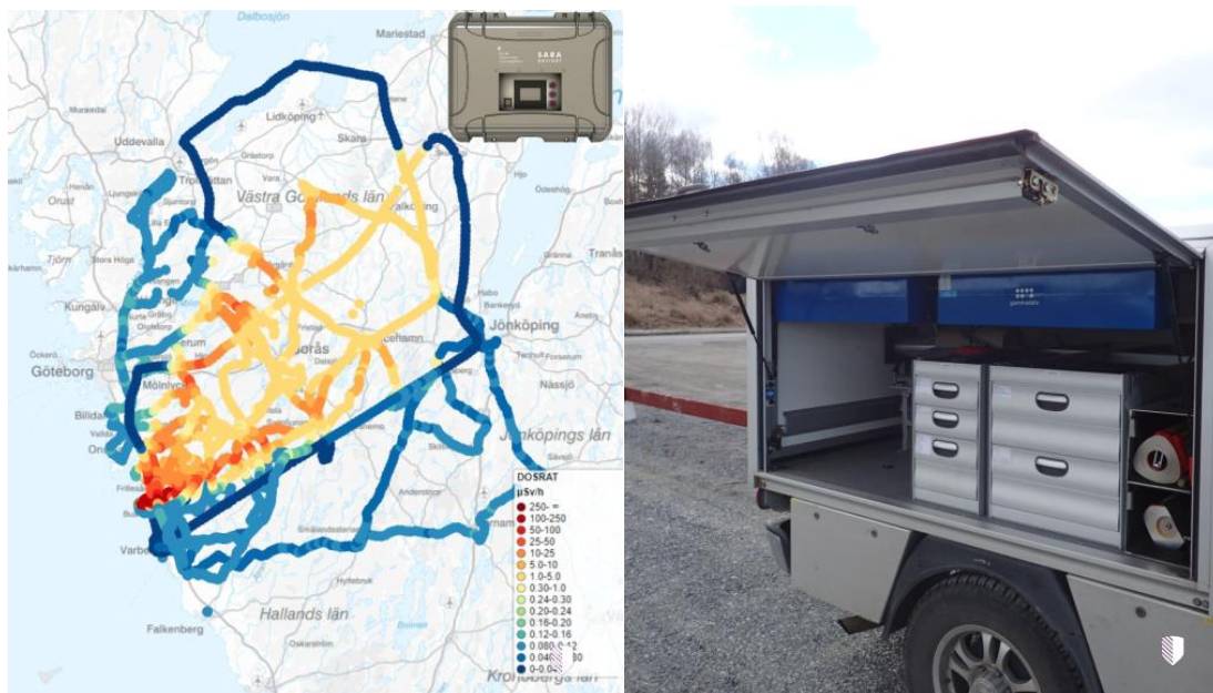
圖 29：輻射偵測車模擬 ARGOS 大氣擴散計算結果
