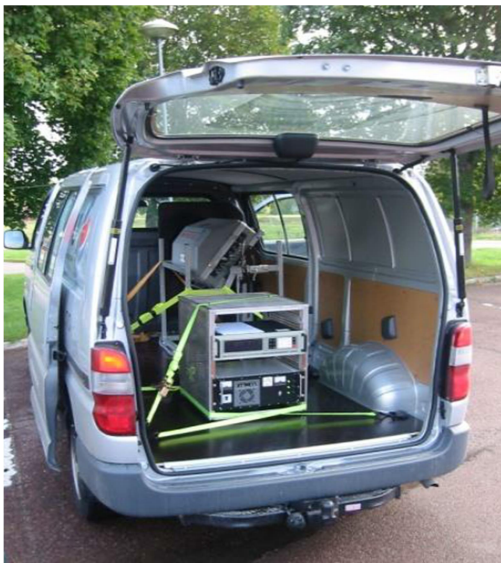
圖 51：平時空中輻射偵測方式測繪地圖，核子事故時車載輻射偵測
