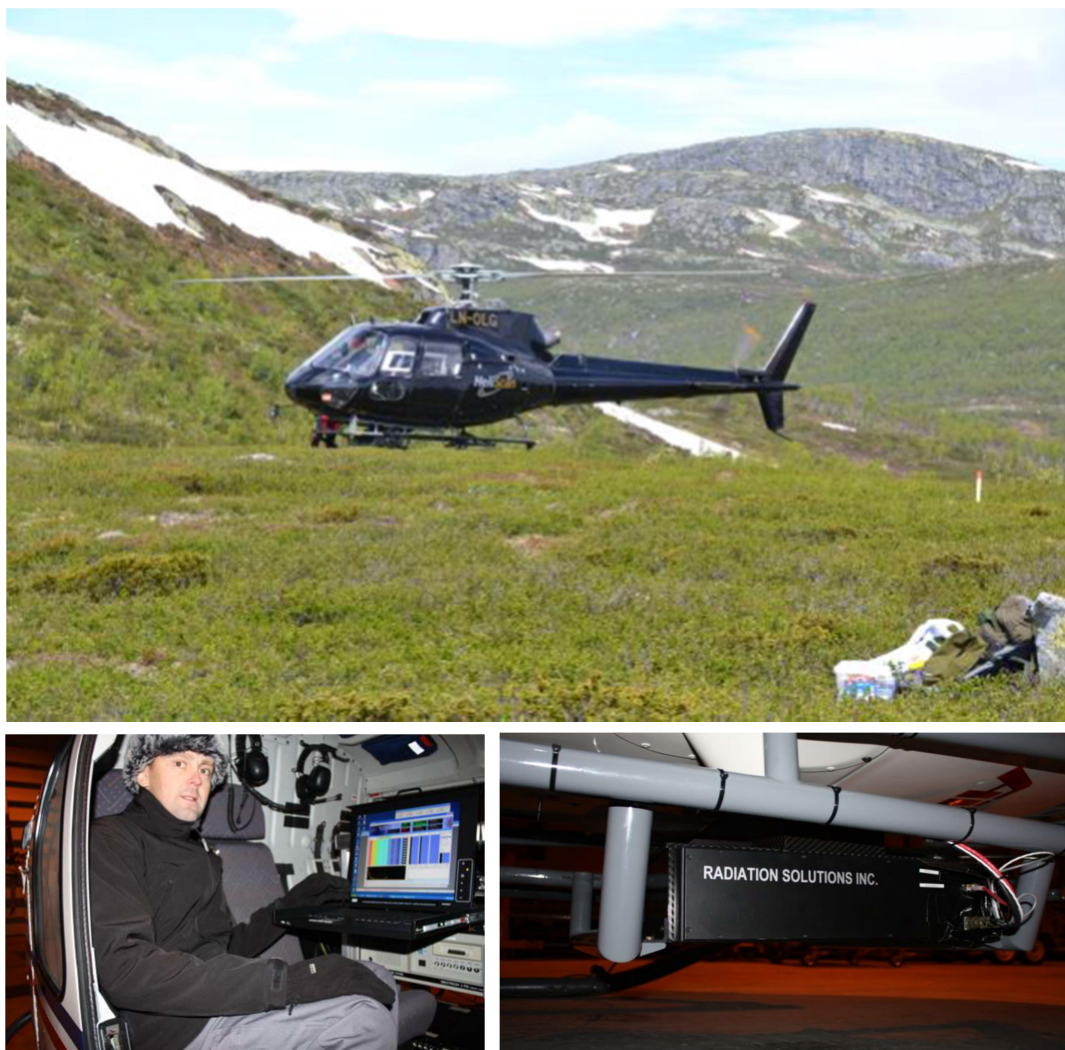
圖 53：挪威直升機搭載的空中輻射偵測系統
