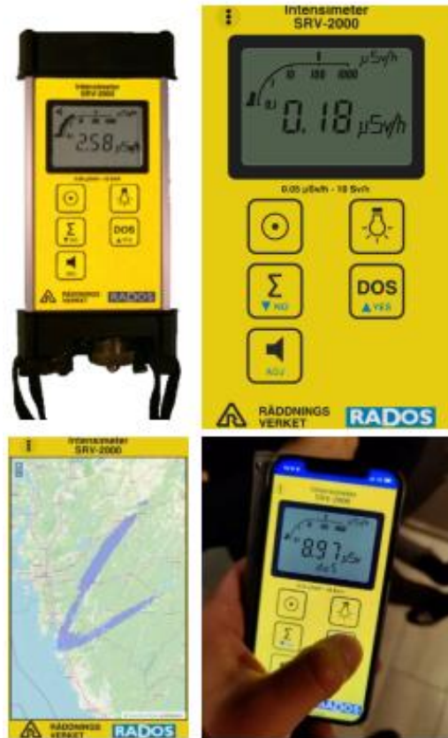
圖 28：配合 SRV-2000/RADOS RDS-200 加馬劑量率儀器進行輻射監測演習
