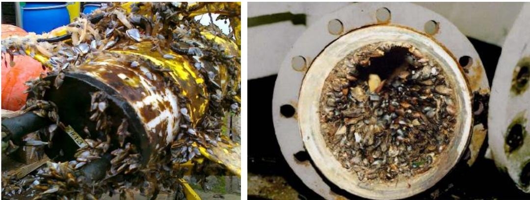
圖 1 被生物垢堆積的管線
