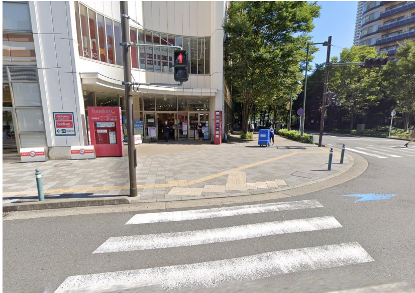
人行道與路面齊平，運用緣石及鋪面形式作為分隔，減少無障礙設施設計
