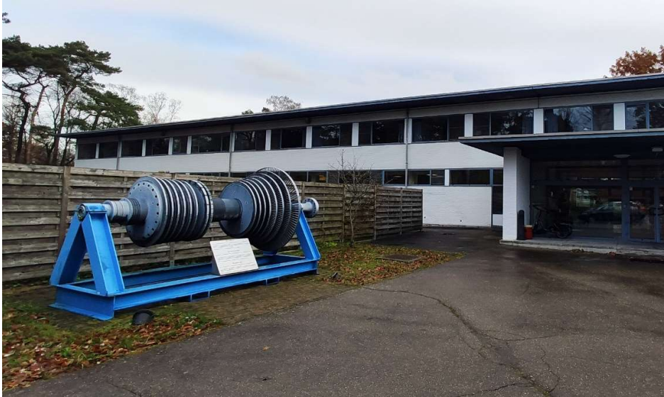
圖 1. BR3 拆下的汽機轉子
