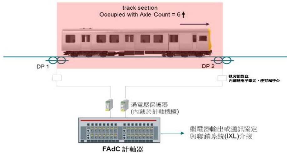
圖 76-計軸器系統之軌道區間偵測型式
