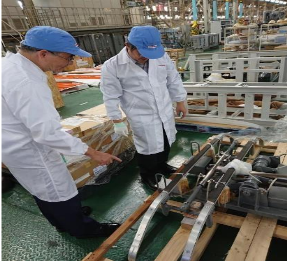
圖 90-工進精工所集電弓(碳刷材質為碳)
