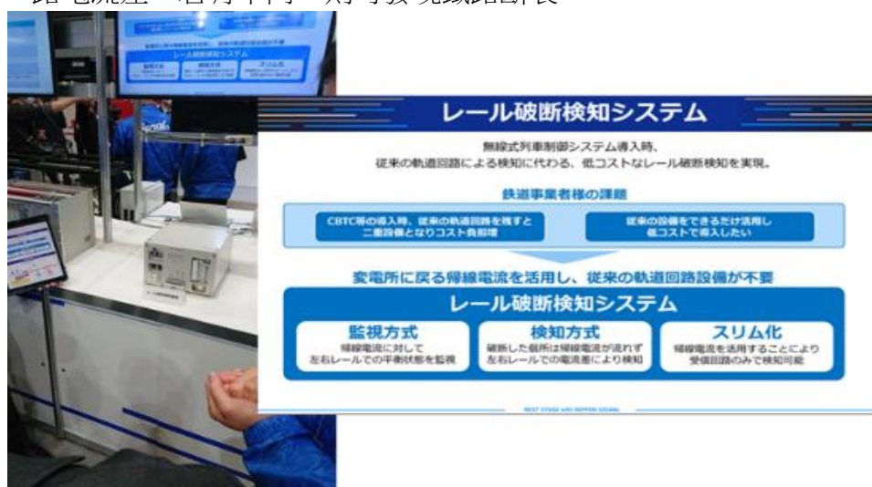
圖 80-鋼軌破損檢測系統
