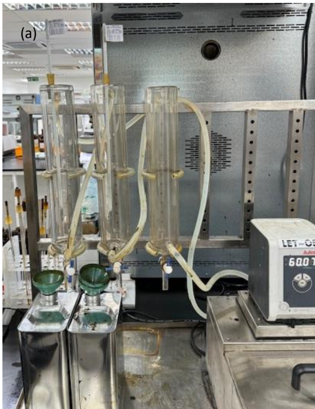
圖五、(a) 密度(ASTM D1298)檢測設備；(b)FAME 含量(EN 14078)檢測儀器
