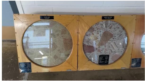
圖 63、混凝土壩體鑽心切片
