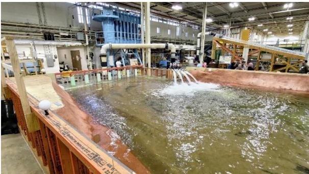
圖 60、模擬水庫低水位調整放水設施情形
