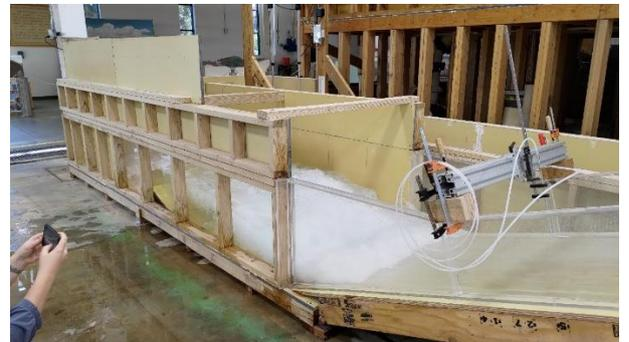
圖 61、模擬水庫校核洪水增加 25%的影響
