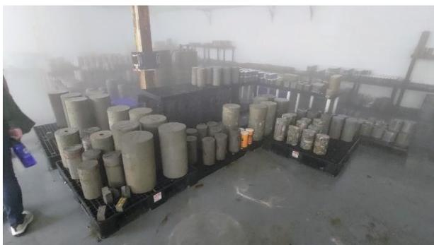
圖 64、混凝土試體的大型保濕室
