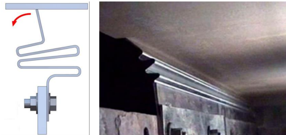
圖 28 軸向氣封示意圖及軸向氣封實際安裝圖
