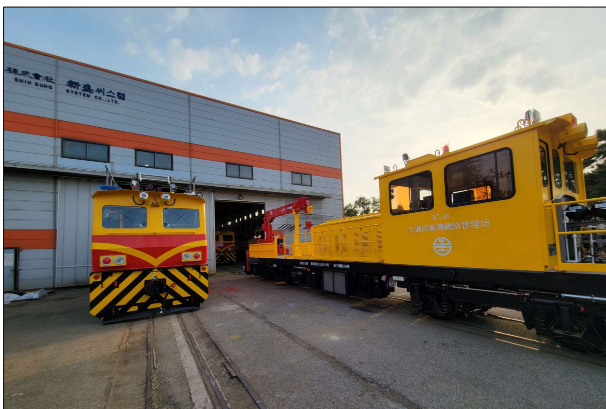
電車線工作車及鐵路吊桿車
