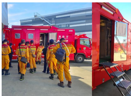
圖 43 大型除污車外觀(左)及單間入口(右)照 說明：單次 4 人同時除污，除污廢水會自動回收，藉由消防車持續供水以長時間使用。
