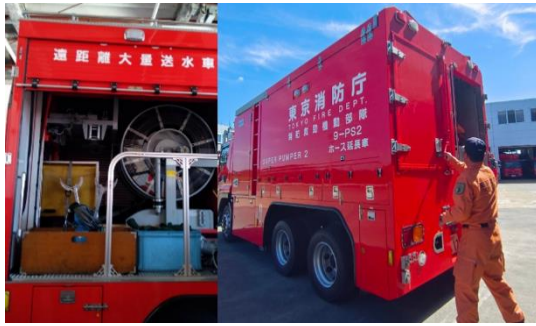
圖 44 長距離送水車內部(左)及外觀(右)照 說明：口徑為 15CM。
