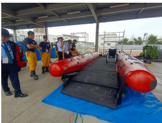
圖 159 第七本部高機能救命船艇介紹 說明：艇面空間較大可置放輪椅，兩側有收合固定裝置。
