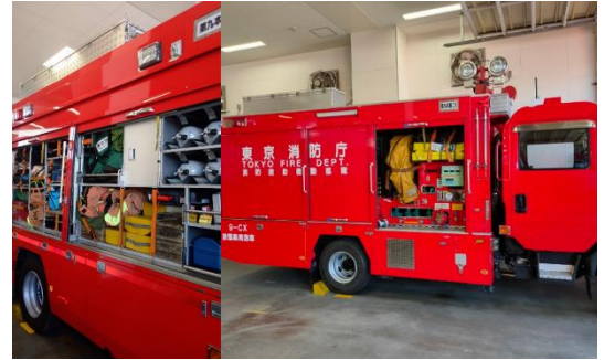
圖 45 排煙高發泡水車內部(左)及外觀(右)照
