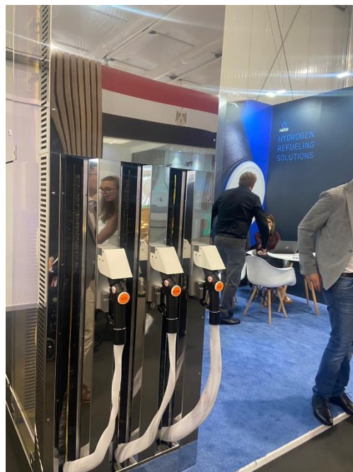
圖 8、HRS 自行研發加氫站實際設備
